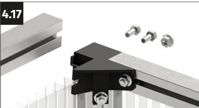
Atornilla ahora el segundo lado del perfil del marco superior. Coge dos tornillos M6x12 mm y una tuerca con brida M6.
