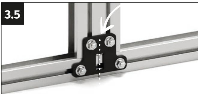
Alinea el perfil doble de modo que la marca en V del centro del perfil doble apunte exactamente a la marca. Atornilla firmemente el conector doble con cuatro tuercas con brida M6.
