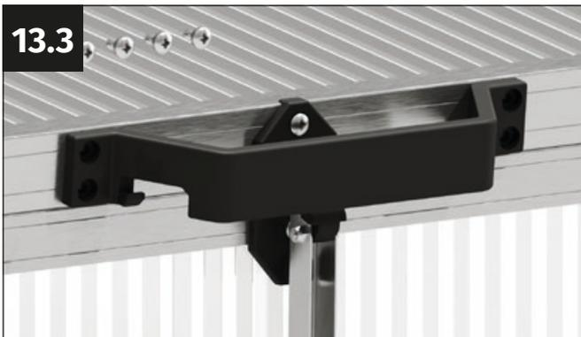
Coloca la manilla de la solapa de forma que las marcas queden exactamente centradas a través de los orificios de la solapa.
