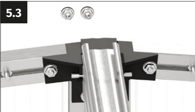
Coloca el perfil de cumbrera sobre el conector y coloca los tornillos M6x12 en las ranuras.
