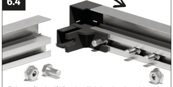
Fija la esquina de plástico al perfil de la solapa lateral. Introduce un tornillo M6x12 mm en la ranura de la esquina de plástico.
