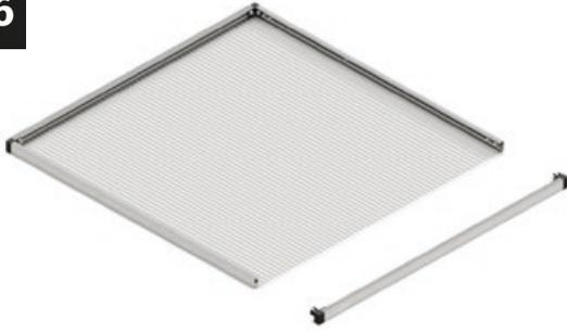
En el siguiente paso, el perfil frontal de la solapa se fija a los perfiles laterales de la solapa. Los siguientes pasos se realizan en paralelo a ambos lados.
