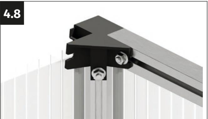
Atornilla el perfil de soporte delantero firmemente con la tuerca con brida M6.
