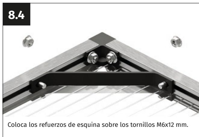
Coloca los refuerzos de esquina sobre los tornillos M6x12 mm.
