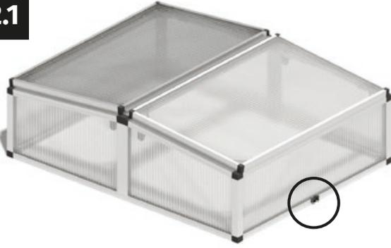
En primer lugar, coloca los ganchos de cierre en el perfil inferior de la estructura delantera.
