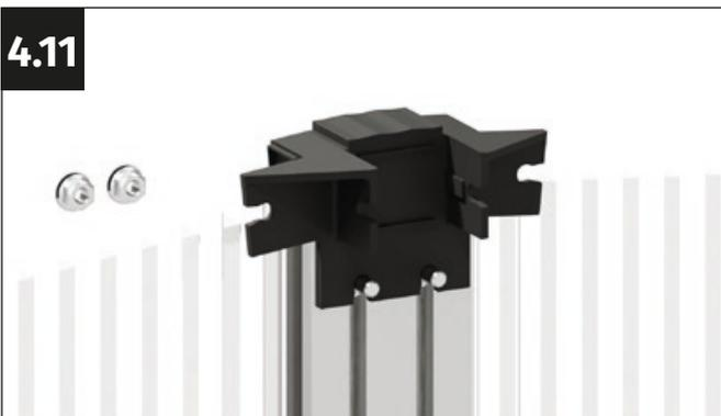
Coloca el conector en el perfil central y coloca los tornillos M6x12 en las ranuras.
