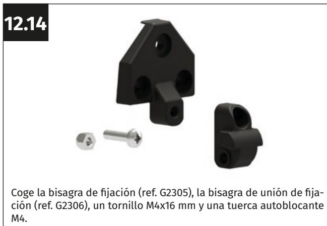
Coge la bisagra de fijación (ref. G2305), la bisagra de unión de fijación (ref. G2306), un tornillo M4x16 mm y una tuerca autoblocante M4.
