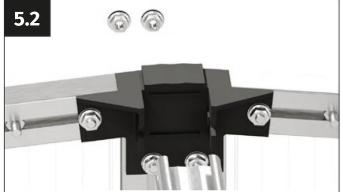
Introduce un tornillo M6x12 mm en cada uno de los dos canales de atornillado del perfil de cumbrera.
