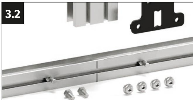
Coge un perfil central, un conector doble (ref. PQS32), dos tornillos M6x12 mm y cuatro tuercas con brida M6. Coloca los tornillos previamente insertados en la marca del perfil de suelo.
