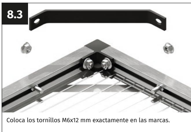
Coloca los tornillos M6x12 mm exactamente en las marcas.
