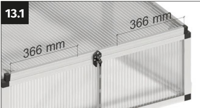
Marca la posición de los tornillos midiendo 366 mm hacia el interior desde el exterior de cada lado del perfil de la solapa.
