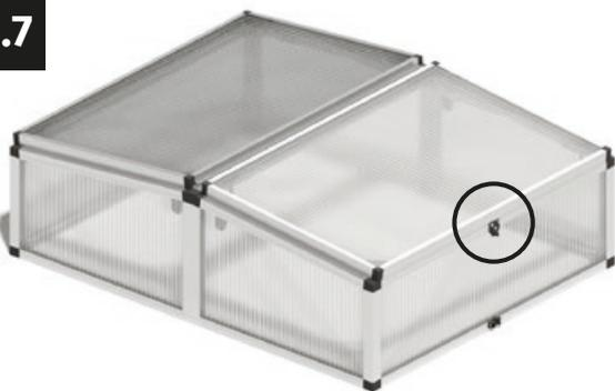
El siguiente paso es colocar las fijaciones del montante en el perfil superior de la estructura...
