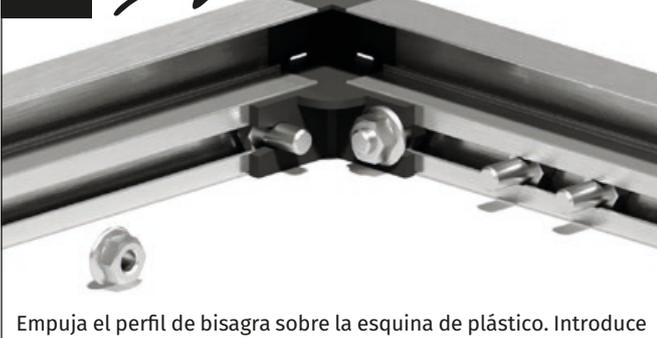
Empuja el perfil de bisagra sobre la esquina de plástico. Introduce el tornillo M6x12 mm en la ranura de la esquina de plástico.
