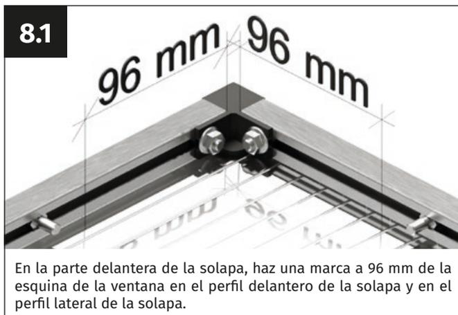
En la parte delantera de la solapa, haz una marca a 96 mm de la esquina de la ventana en el perfil delantero de la solapa y en el perfil lateral de la solapa.
