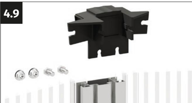
Coloca el conector del perfil de cumbrera sobre el perfil de acoplamiento. Utiliza el conector, dos tornillos M6x12 mm y dos tuercas con brida M6.
