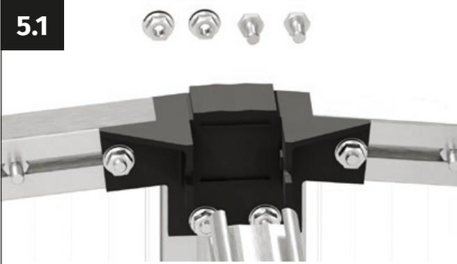
Coge el perfil de cumbrera (longitud 975 mm) y dos tornillos M6x12 mm y dos tuercas con brida.
