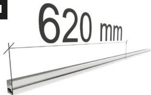
Toma los dos perfiles de suelo de la pared lateral. Mide 620 mm hacia dentro desde el borde de corte del perfil y haz una marca.
