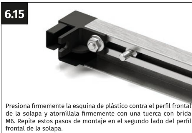
Presiona firmemente la esquina de plástico contra el perfil frontal de la solapa y atorníllala firmemente con una tuerca con brida M6. Repite estos pasos de montaje en el segundo lado del perfil frontal de la solapa.
