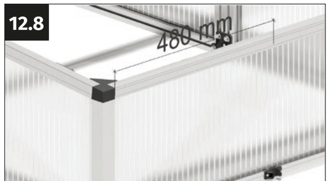
Marca la posición del soporte de fijación midiendo 480 mm hacia dentro desde el lateral del perfil de soporte superior.
