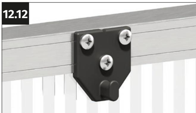
Atornilla el soporte con los tres tornillos autorroscantes de 4,8x13 mm.
