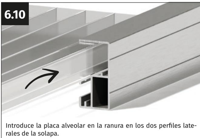
Introduce la placa alveolar en la ranura en los dos perfiles laterales de la solapa.
