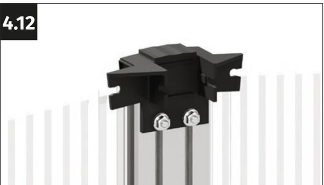
Presiona el conector con firmeza y atornilla el perfil central firmemente a las tuercas con brida M6.
