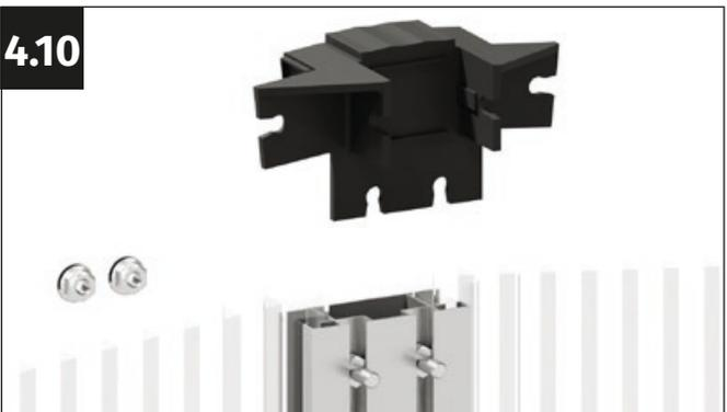
Introduce un tornillo M6x12 mm en cada uno de los dos canales de atornillado del perfil central.
