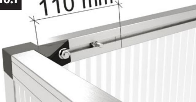
Faites une marque sur le profilé supérieur latéral du cadre, mesurée à partir du coin de la fenêtre, selon 110 mm.
