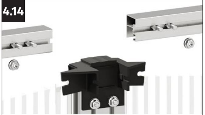
Führen Sie jeweils zwei Schrauben M6x12 mm in den Schraubkanal des oberen Rahmenprofils ein.
