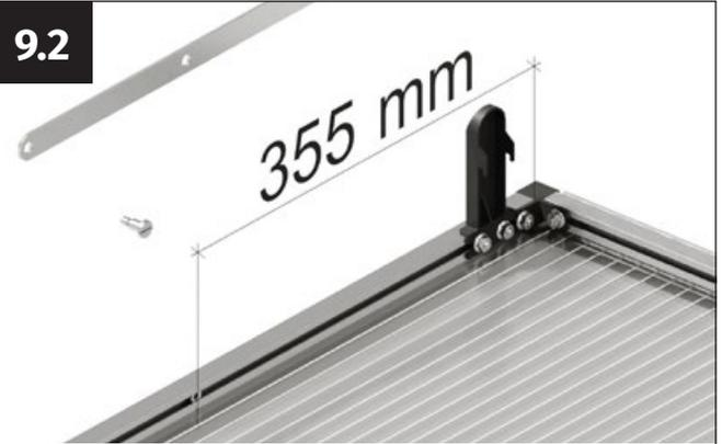
Positionnez l'écrou M6 exactement sur le repère.
