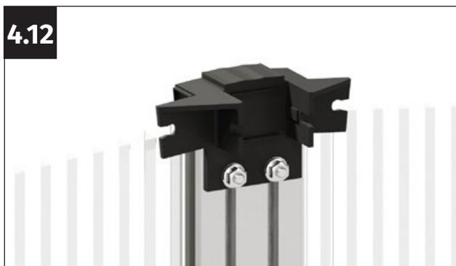
Appuyez fermement sur le connecteur et vissez fermement le profilé central avec les écrous à bride M6.
