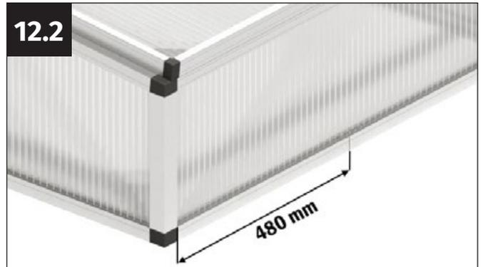
Marquez la position du crochet d'arrêt inférieur en mesurant 480 mm vers l'intérieur à partir du côté du profilé inférieur.
