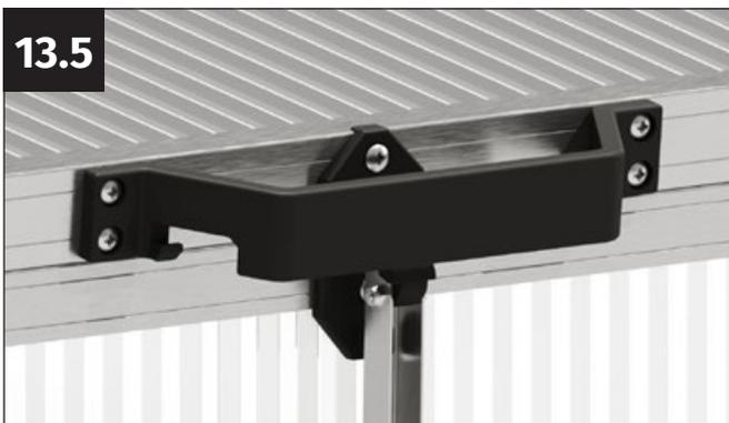
Vissez la poignée de fenêtre avec les quatre vis à tôle autoperceuses 4,8x13 mm.
