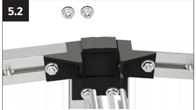
Introduisez une vis M6x12 mm dans chacun des deux canaux de vissage du profilé de faîtière.
