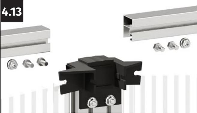
Prenez deux profilés de cadre supérieurs (longueur 592 mm) ainsi que quatre vis M6x12 mm et deux écrous à bride.
