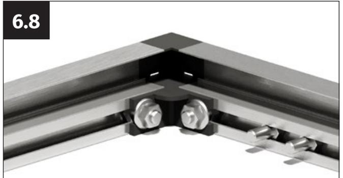
Appuyez fermement le profilé de charnière contre l'équerre d'angle en plastique et le vissez fermement avec l'écrou à embase M6.
