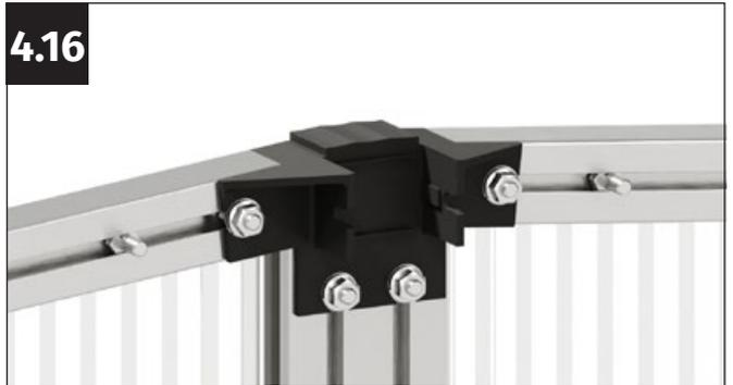
Appuyez fermement le profilé de cadre supérieur contre le connecteur et vissez fermement le profilé de cadre à l'aide d'un écrou à bride M6.
