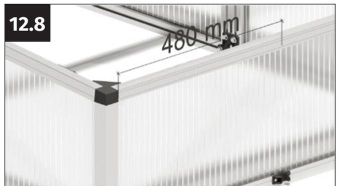
Marquez la position de la fixation du support en mesurant 480 mm vers l'intérieur à partir du côté du profil d'appui supérieur.
