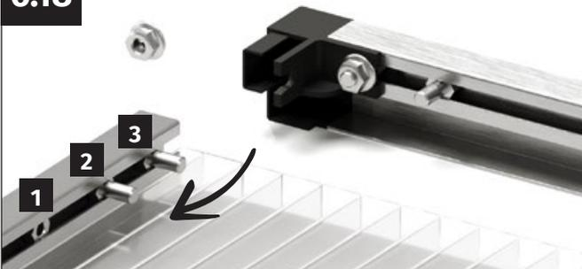
De chaque côté, insérez d'abord l'écrou M6, puis les deux vis M6x12 mm dans le canal de vissage des profilés latéraux de la fenêtre. **Veillez impérativement respecter l'ordre de passage !**
