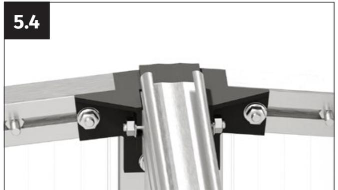
Appuyez fermement le profilé de faîtière contre le connecteur et vissez fermement la faîtière avec les écrous à bride M6.
