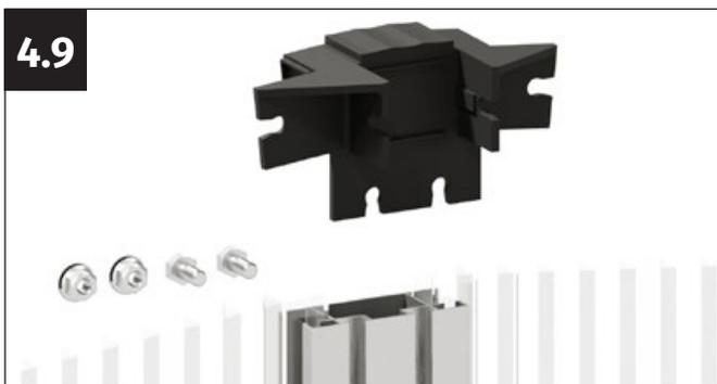
Placez le connecteur du profilé de façade sur le profilé de jonction. Pour cela, prenez le connecteur, deux vis M6x12 mm et deux écrous à bride M6.
