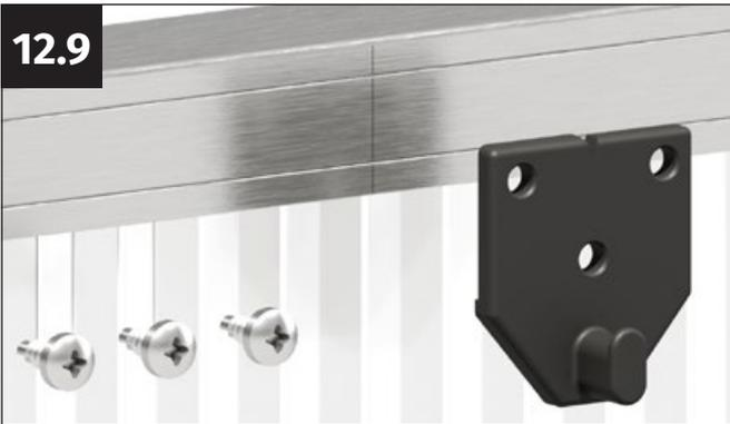
Munissez-vous de la fixation pour potence (pièce n° G2301) et de trois vis à tôle autoforeuses 4,8x13 mm.
