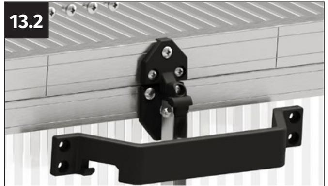
Munissez-vous de la poignée de fenêtre (pièce n° G2316) et de quatre vis à tôle autoperceuses 4,8x13 mm.
