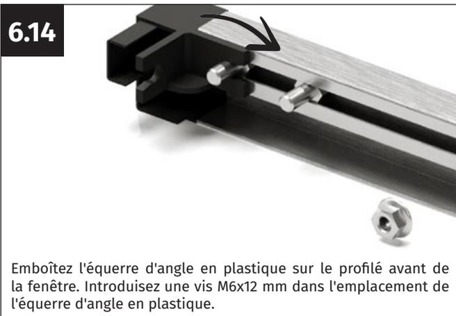
Emboîtez l'équerre d'angle en plastique sur le profilé avant de la fenêtre. Introduisez une vis M6x12 mm dans l'emplacement de l'équerre d'angle en plastique.
