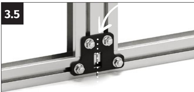
Alignez le profilé double de manière à ce que le repère en V au milieu du profilé double pointe exactement sur le repère apposé. Visser fermement le double connecteur avec quatre écrous à bride M6.
