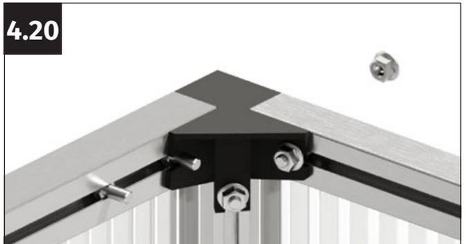
Emboîtez le profilé supérieur du cadre sur la cornière d'angle et positionnez une vis M6x12 mm.
