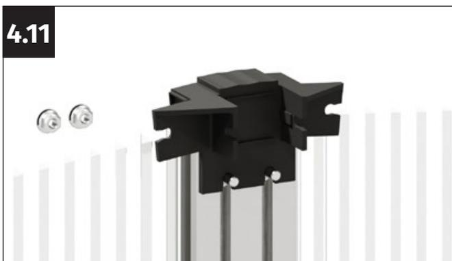
Placez le connecteur sur le profilé central et positionnez les vis M6x12 dans ses évidements.
