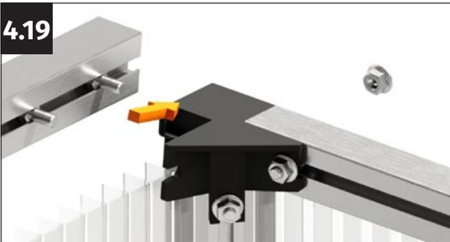
Pour pouvoir emboîter le profilé d'encadrement supérieur sur le connecteur de fixation, il faut auparavant pousser légèrement le profilé d'angle vers l'avant.
