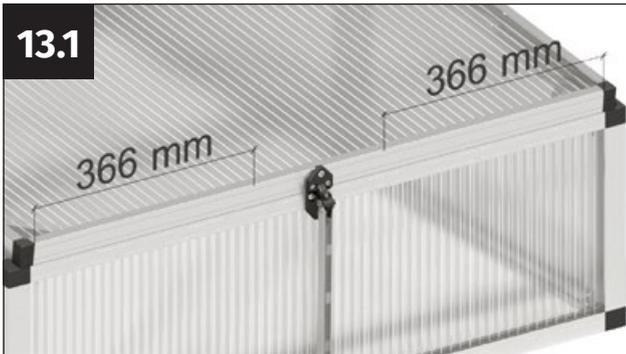
Marquez la position des trous de perçage en mesurant 366 mm de chaque côté du profil de la fenêtre, de l'extérieur vers l'intérieur.
