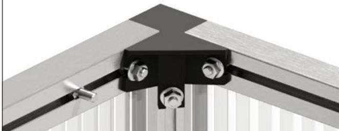
Appuyez fermement la cornière d'angle contre le profilé supérieur du cadre et vissez fermement le profilé supérieur du cadre avec l'écrou à bride M6.
