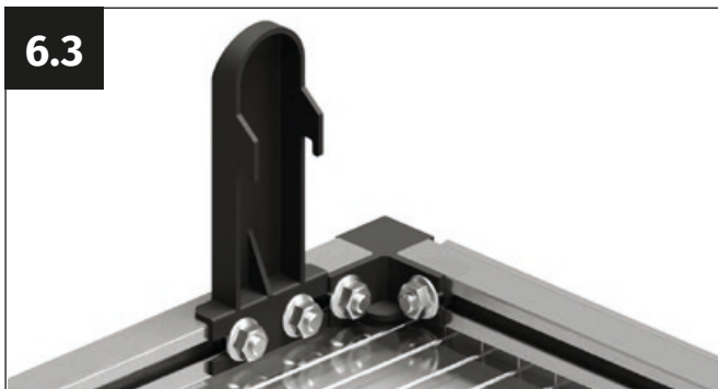
6.3 Drücken Sie die Verschiebesicherung leicht gegen den hinteren Kunststoffknoten und verschrauben Sie sie mit den zwei Flanschmuttern M6.
