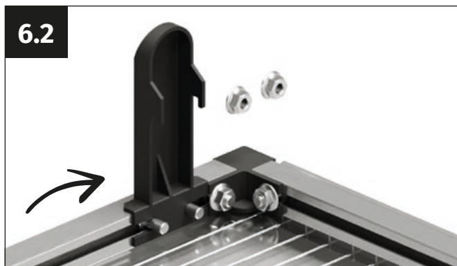
6.2 Plaats de schuifblokkering in de achterste hoeken van de klep op de zijprofielen.
