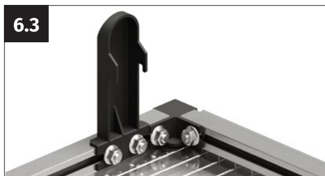
Lekko dociśnij blokadę przesuwu do tylnego profilu narożnego i przykręć ją za pomocą dwóch nakrętek kołnierzowych M6.
