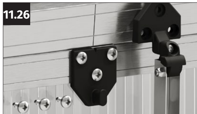
11.26 Przykręć zaczep za pomocą trzech wkrętów samogwintujących 4,8x13 mm.
