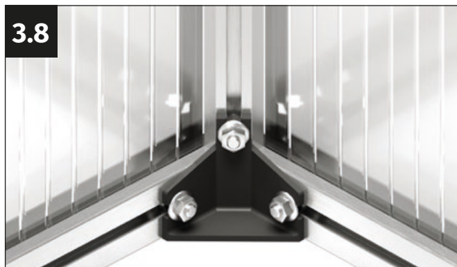
Asegúrate de que las placas se introducen en las ranuras en U de los perfiles de suelo hasta el tope.
