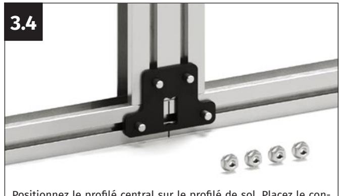
Positionnez le profilé central sur le profilé de sol. Placez le connecteur double de manière à ce qu'une vis M6x12 mm dépasse à chaque fois à travers les trous du profilé double.
