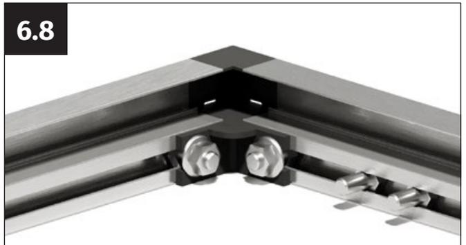
Appuyez fermement le profilé de charnière contre l'équerre d'angle en plastique et le visser fermement avec l'écrou à embase M6.
