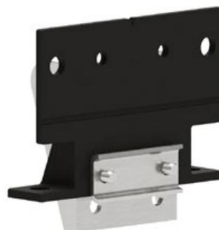
Vissez fermement l'ouvre-fenêtre métallique sur la pièce de serrage à l'aide des deux vis M4x12 mm.
