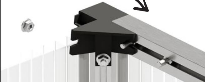
Emboîtez le profilé d'appui avant sur l'équerre d'angle et positionnez une vis M6x12 mm dans son évidement.
