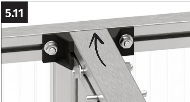
Insérez le profilé d'appui entre les deux connecteurs en plastique. Commencez par la paroi arrière. Poussez légèrement la paroi avant vers l'extérieur pour faire de la place pour insérer le profilé.
