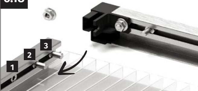
De chaque côté, insérez d'abord l'écrou M6, puis les deux vis M6x12 mm dans le canal de vissage des profilés latéraux de la fenêtre. **Veillez impérativement respecter l'ordre de passage !**
