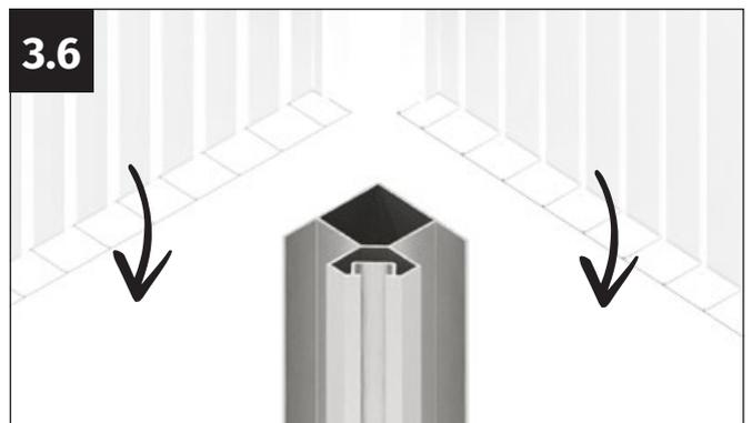
Insérez les panneaux double paroi par le haut dans les rainures en U des profilés d'angle.
