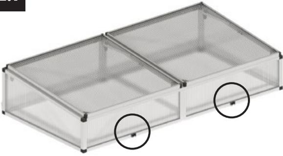
La première chose à faire est de monter les crochets d'ouverture-fenêtre sur le profilé inférieur avant du cadre.
