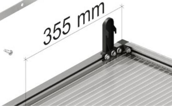
Faites une marque à l'arrière du battant de la fenêtre sur le profilé latéral de la fenêtre, mesurée à partir du coin de la fenêtre, après 355 mm.
