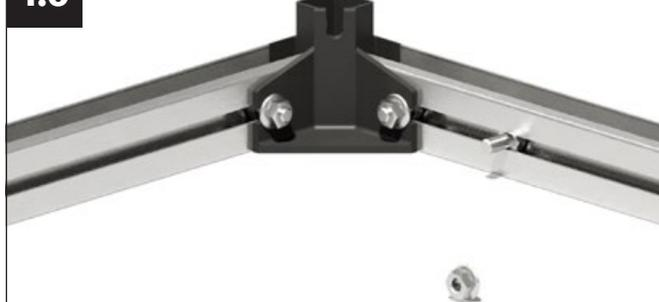
Vérifiez que les profilés de sol reposent fermement contre l'équerre d'angle du cadre inférieur et vissez fermement les profilés de sol avec les écrous à bride M6.
