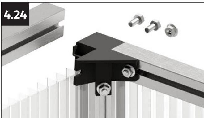
Prenez deux vis M6x12 mm et un écrou à bride M6.
