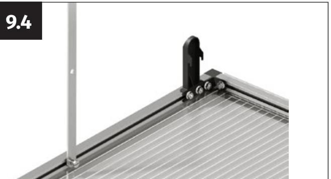
Vissez la vis à tête plate M6 avec l'écrou M6. Assurez-vous que la vis dépasse complètement du trou du support.
