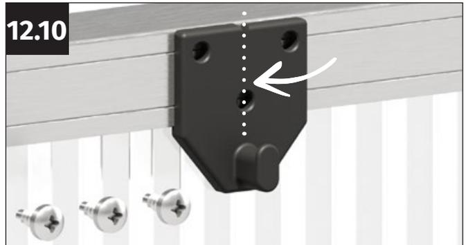
Positionnez la fixation exactement au centre du repère apposé. Veillez à ce que la rainure en V de la fixation soit directement orientée vers le repère.
