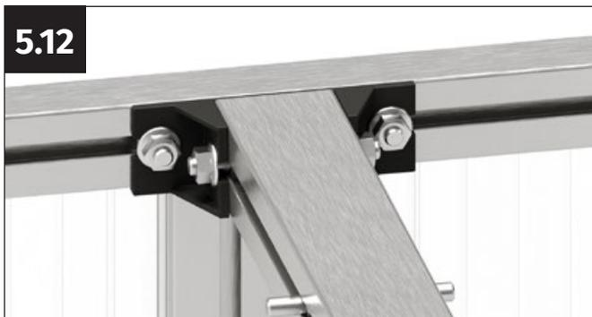
Introduisez les vis M6x12 mm dans l'évidement du connecteur en plastique et vissez fermement le profilé avec les écrous à bride M6.
