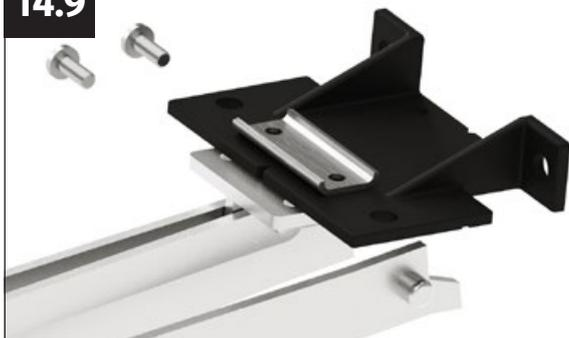
Positionnez la pièce de serrage de l'ouvre-fenêtre sur la fixation en plastique.
