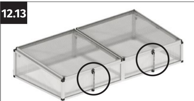
Assemblez ensuite les entrebâilleurs de fenêtre et montez-les sur le vantail de la fenêtre.
