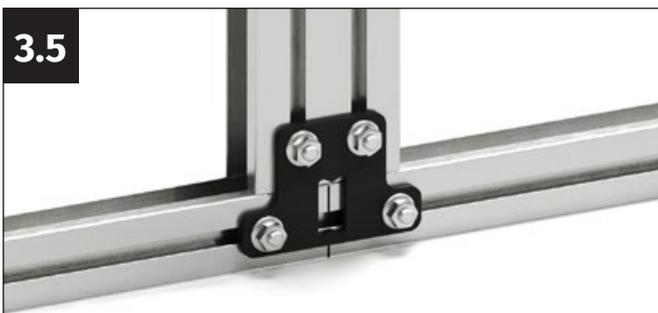
Alignez le profilé double de manière à ce que le repère en V au milieu du profilé double pointe exactement sur le repère apposé. Vissez fermement le connecteur double avec quatre écrous à embase M6.
