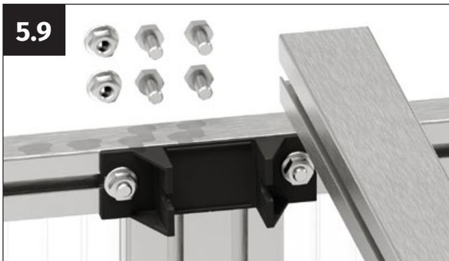
Saisissez le profilé d'appui, quatre vis M6x12 mm et deux écrous à bride M6.
