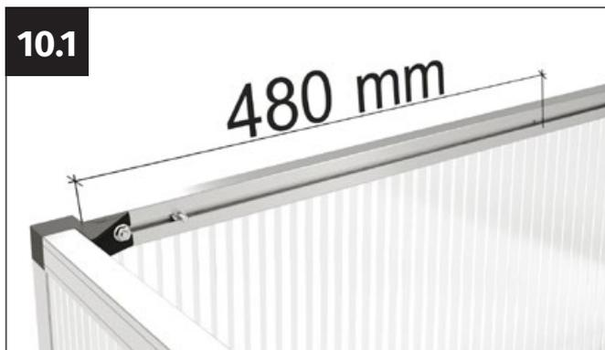
Faites une marque sur le profilé supérieur latéral du cadre, mesurée à partir du coin de la fenêtre, selon 480 mm.
