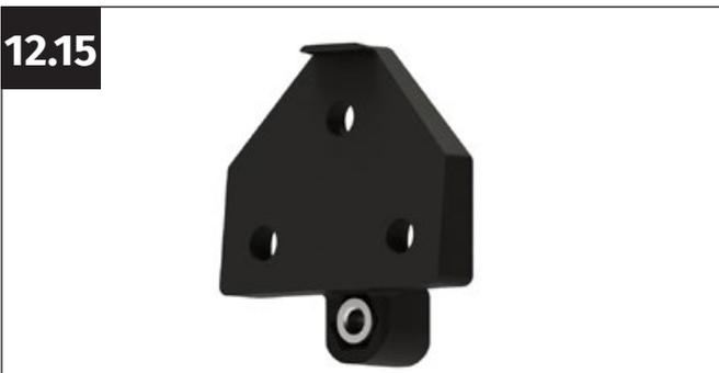
Insérez l'écrou autobloquant M4 dans l'évidement prévu dans la charnière du support. L'anneau bleu de l'écrou est tourné vers l'arrière.
