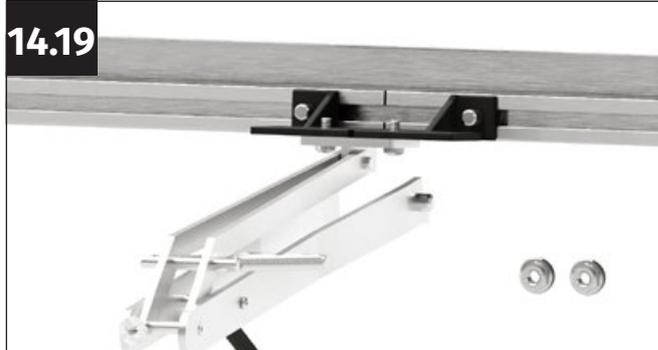
Placez la fixation sur le profilé de fenêtre de manière à ce que les deux vis losange M6 passent à travers les trous.
