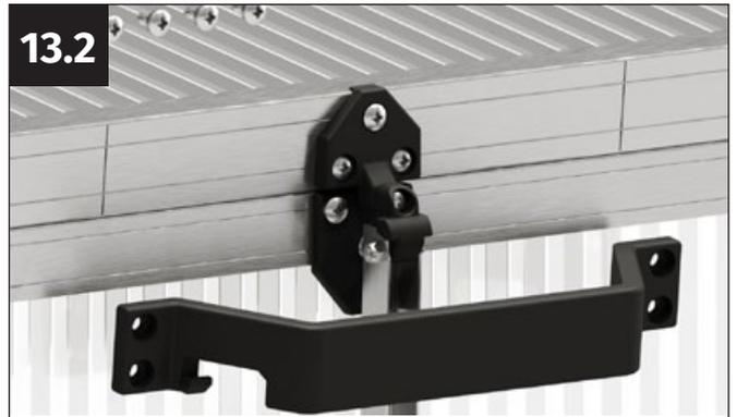
Prenez la poignée de fenêtre (pièce G2316) et quatre vis à tôle autopercées 4,8x13 mm.
