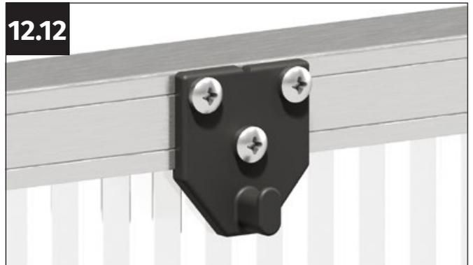
Vissez la fixation avec les trois vis à tôle autoperceuses 4,8x13 mm.
