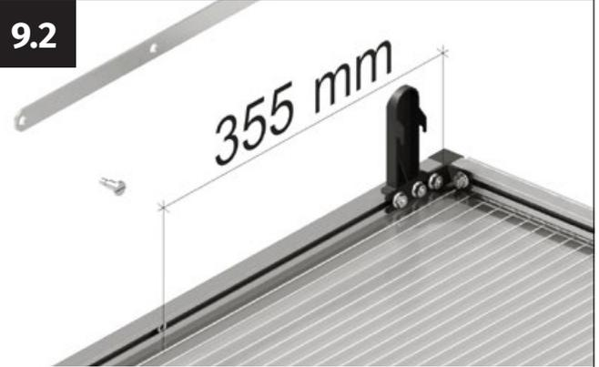
Positionnez l'écrou M6 exactement sur le repère.
