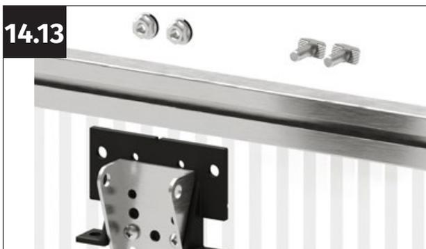
Prenez la fixation préparée avec l'ouvre-fenêtre métallique et deux vis losange M6 et deux écrous à embase M6"
