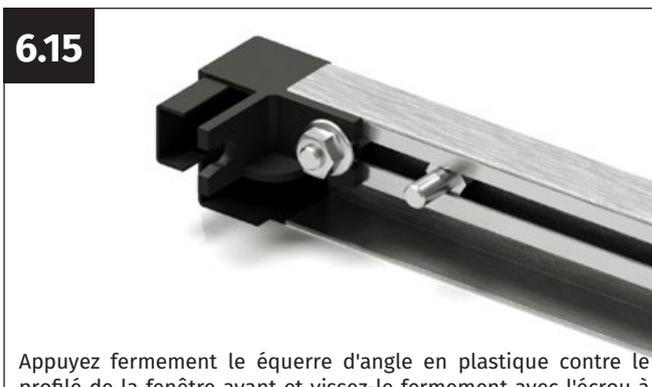
Appuyez fermement le équerre d'angle en plastique contre le profilé de la fenêtre avant et vissez-le fermement avec l'écrou à bride M6. Répétez ces étapes de montage sur le deuxième côté du profilé de fenêtre avant.
