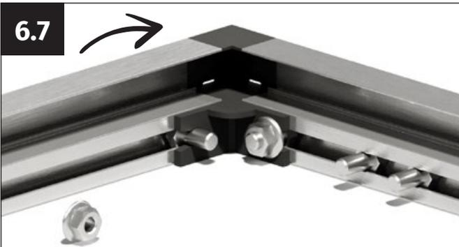
Emboîtez le profilé de charnière sur le coin en plastique. Introduisez la vis M6x12 mm dans l'évidement de l'équerre d'angle en plastique.
