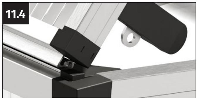
Une fois le battant de la fenêtre introduit sur toute sa largeur, fermez-le avec précaution. Les deux sécurités anti-déplacement s'enclenchent dans le cadre et positionnent le battant de fenêtre exactement au centre.
