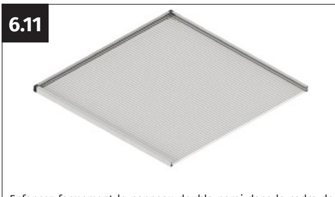
Enfoncez fermement le panneau double paroi dans le cadre de manière à ce qu'il bute fermement contre la butée dans le "U" formé par le profilé de charnière.
