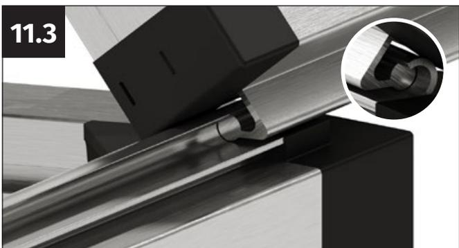
Introduisez la partie charnière du battant de fenêtre dans la contrepartie du cadre et insérez le battant de fenêtre sur toute sa largeur.
