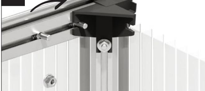
Emboîtez la charnière de toit sur la cornière d'angle arrière et positionnez une vis M6x12 mm dans son évidement.
