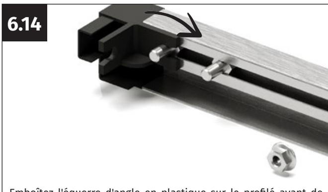
Emboîtez l'équerre d'angle en plastique sur le profilé avant de la fenêtre. Introduisez une vis M6x12 mm dans l'emplacement de l'équerre d'angle en plastique.
