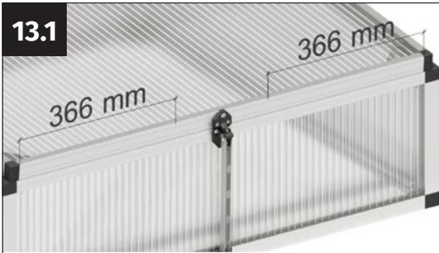
Marquez la position des trous de perçage. Mesurez 366 mm de chaque côté à partir de l'extérieur du profilé de fenêtre vers l'intérieur.
