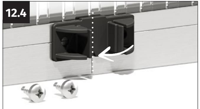
Positionnez le crochet d'ouvre-fenêtre exactement au centre du repère apposé. Veillez à ce que la rainure en V du crochet soit directement orientée vers le repère.
