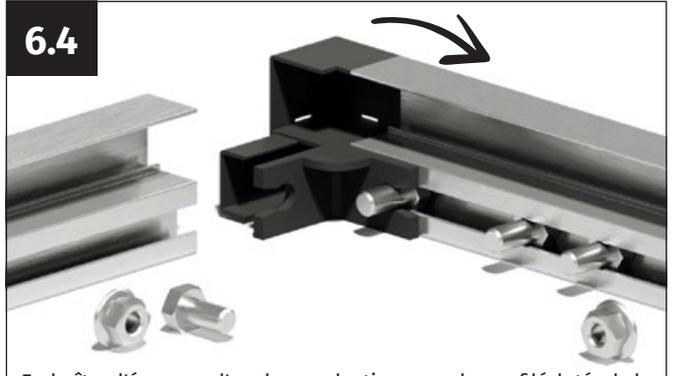
Emboîtez l'équerre d'angle en plastique sur le profilé latéral de la fenêtre. Introduisez une vis M6x12 mm dans l'emplacement de l'équerre d'angle en plastique.
