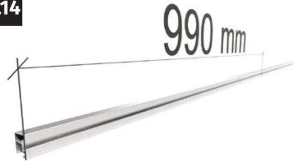
Nehmen Sie das obere Profil der Frontwand zur Hand. Markieren Sie die Mitte des Profils, indem Sie exakt 990 mm von der Schnittkante nach innen messen.
