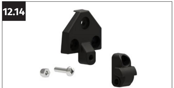
Prenez la charnière du support (pièce G2305), la charnière du connecteur du support (pièce G2306), ainsi qu'une vis M4x16 mm et un écrou autobloquant M4.
