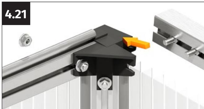
Pour pouvoir emboîter le profilé d'encadrement supérieur sur l'équerre de fixation, il faut auparavant pousser légèrement le profilé d'angle vers l'arrière.
