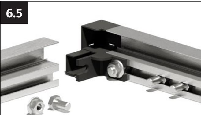
Appuyez fermement l'équerre d'angle en plastique contre le profilé latéral de la fenêtre et la visser solidement avec l'écrou à bride M6.
