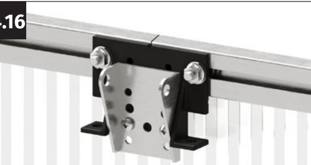
Positionnez la fixation exactement au milieu du profilé supérieur. Veillez à ce que la rainure en V de la fixation soit exactement alignée sur le repère. Vissez ensuite fermement la fixation avec deux écrous à bride M6.
