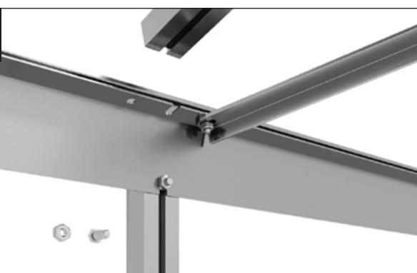
Préparez une entretoise de toit, une vis M6x12 mm et un écrou à embase M6 pour le montage.
