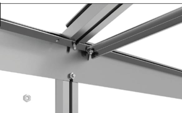
Posez l'entretoise de toit sur la gouttière. Positionnez la vis M6x12 mm dans la découpe de la gouttière.
