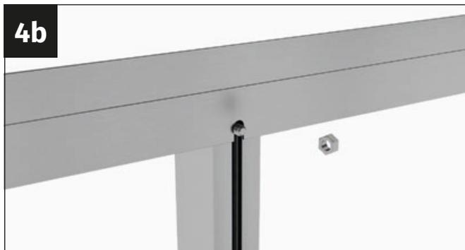
Introduisez une vis M6x12 mm dans le canal de vissage du profilé d'entrée de porte et positionnez-la dans la découpe de l'entretoise.
