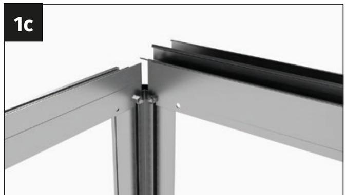
Vissez fermement la traverse sur le profilé d'angle latéral à l'aide d'un écrou à bride M6.
