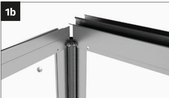
Introduisez la vis M6x12 mm dans le canal de vissage du profilé d'angle latéral et placez l'entretoise.
