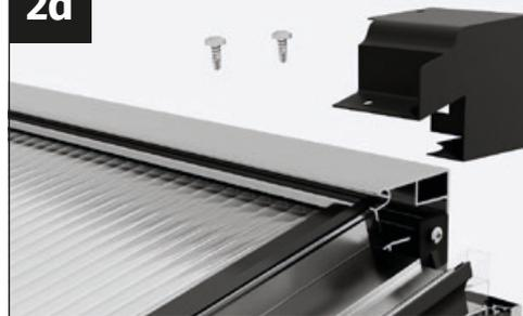
Préparez le capuchon de la faîtière et deux vis auto-perceuses 4,8 x 13 mm pour le montage. Nous recommandons de pré-percer avec un foret de 4 mm malgré les vis auto-perceuses.
