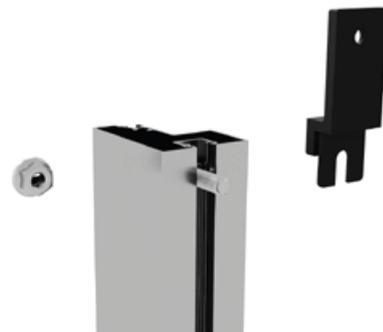
Introduisez une vis M6x12 mm dans le canal de vissage du support de toit.
