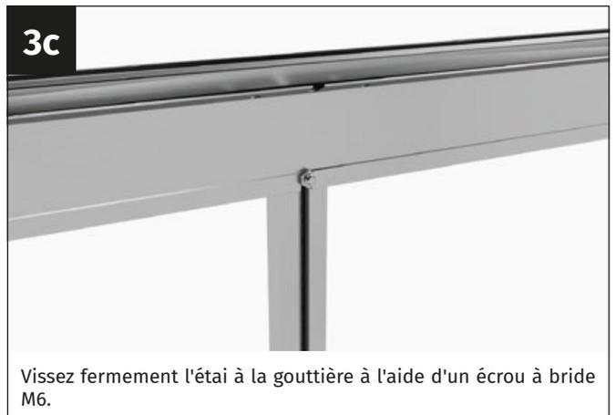
Vissez fermement l'étau à la gouttière à l'aide d'un écrou à bride M6.
