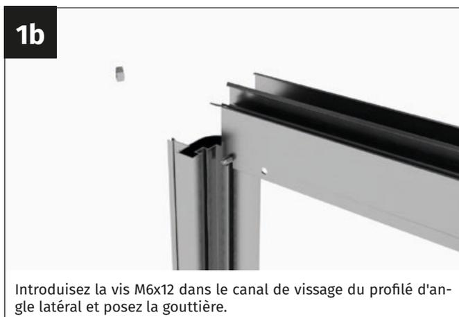
Introduisez la vis M6x12 dans le canal de vissage du profilé d'angle latéral et posez la gouttière.
