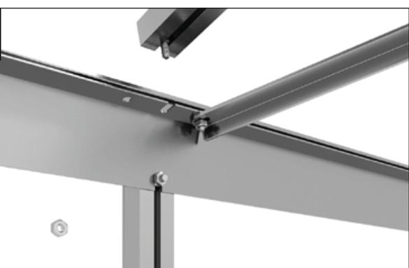
Introduisez la vis M6x12 mm dans le canal de vissage de l'entretoise de toit.
