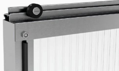
Vissez le boulon d'essieu avec l'écrou. **Nous recommandons de positionner chaque galet de porte à environ 40 mm de l'extrémité du profilé de guidage de porte.**
