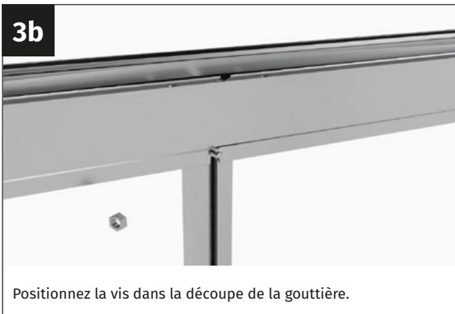
Positionnez la vis dans la découpe de la gouttière.
