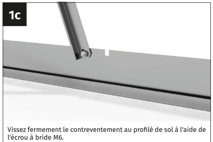
Vissez fermement le contreventement au profilé de sol à l'aide de l'écrou à bride M6.
