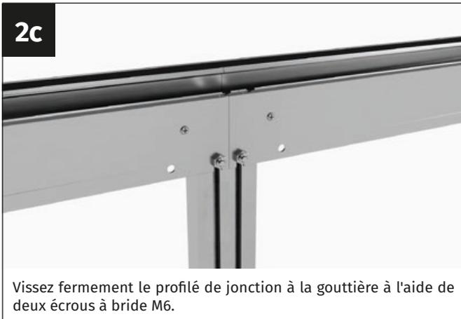
Vissez fermement le profilé de jonction à la gouttière à l'aide de deux écrous à bride M6.
