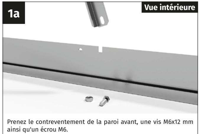
Prenez le contreventement de la paroi avant, une vis M6x12 mm ainsi qu'un écrou M6.
