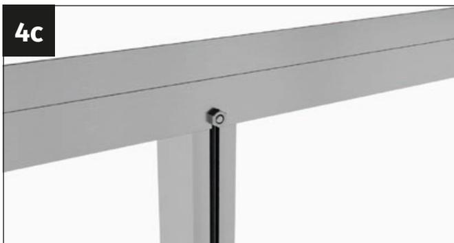
Vissez fermement le profilé d'entrée de porte à l'entretoise à l'aide d'un écrou à bride M6.
