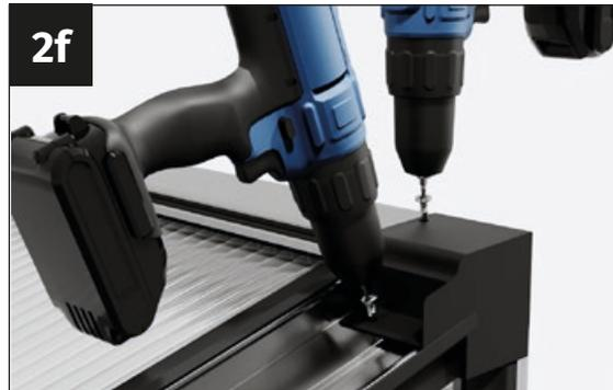
Vissez le cache de faîtière avec les vis auto-perceuses 4,8 x 13 mm. Il est recommandé de pré-percer avec un foret de 4 mm avant de visser.
