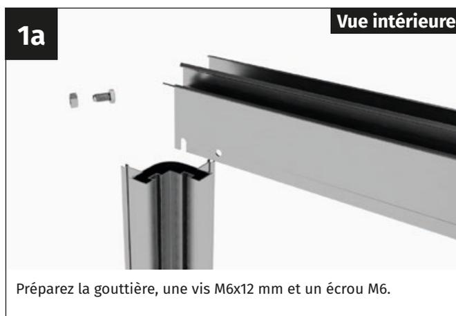
Préparez la gouttière, une vis M6x12 mm et un écrou M6.
