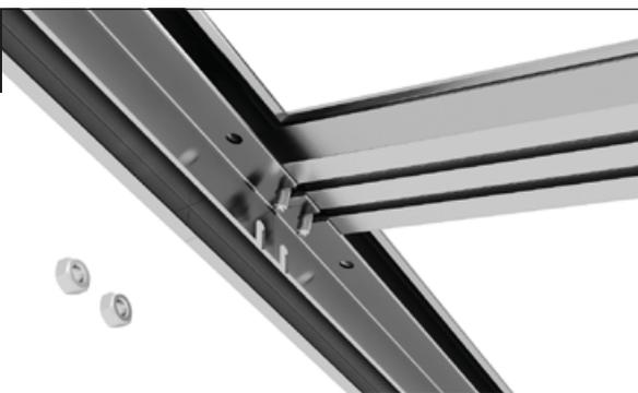
Posez le profilé de jonction sur le profilé de faîtière. Positionnez les vis M6x12 mm dans les découpes de la faîtière.
