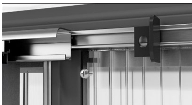
Sett inn dørskinnebeskyttelsen på den siden av dørskinnen som peker bort fra takrenna. Bruk boreskruen 4,8×13 mm til å montere dørskinnebeskyttelsen.
