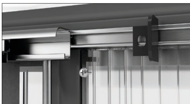
Sæt dørskinnebeskyttelsen på den side af dørskinnen, der vender væk fra tagrenden. Brug boreskruen 4,8×13 mm til at fastgøre dørskinnebeskyttelsen.
