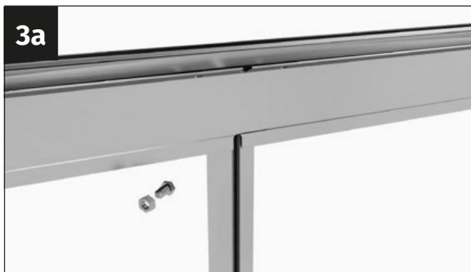
Introduce un tornillo M6x12 mm en el canal para tornillos del puntal.
