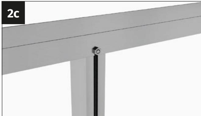
Atornilla firmemente el perfil de entrada de la puerta al refuerzo transversal con una tuerca con brida M6.
