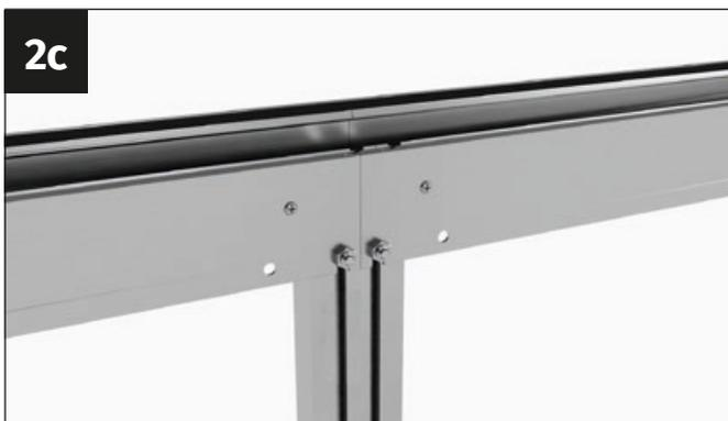
Atornilla firmemente el perfil de acoplamiento al canalón con dos tuercas con brida M6.
