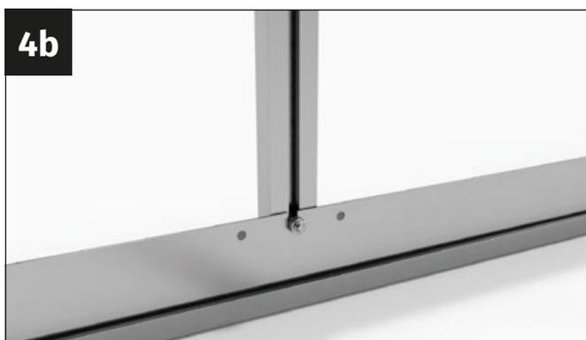
Atornilla firmemente el puntal al perfil del suelo con una tuerca con brida M6.
