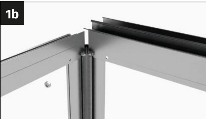
Introduce el tornillo M6x12 mm en el canal para tornillos del perfil lateral angular y fija el refuerzo transversal.
