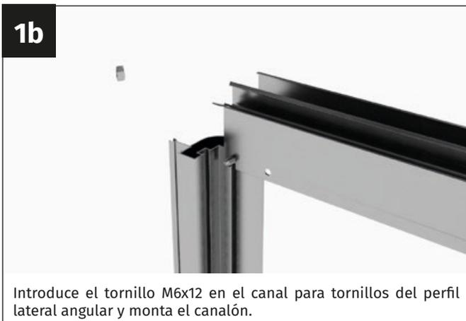
Introduce el tornillo M6x12 en el canal para tornillos del perfil lateral angular y monta el canalón.
