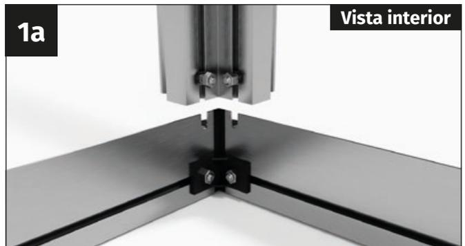
Introduce dos tornillos M6x12 mm en los canales para tornillos del perfil lateral angular. Fija los tornillos con tuercas con brida M6 para evitar que resbalen.
