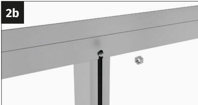
Introduce un tornillo M6x12 mm en el canal de atornillado del perfil de entrada de la puerta y colócalo en la sección perforada de los refuerzos transversales.
