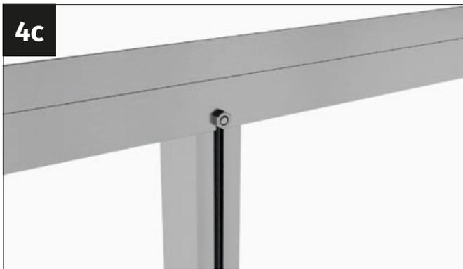
Atornille firmemente el perfil de entrada de la puerta al refuerzo transversal con una tuerca con brida M6.
