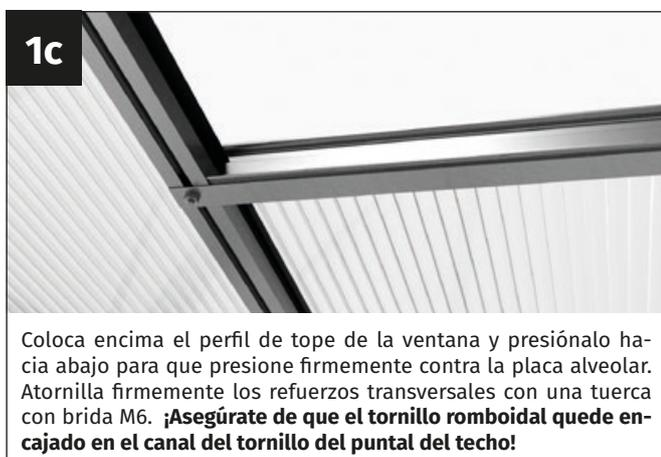
Coloca encima el perfil de tope de la ventana y presiónalo hacia abajo para que presione firmemente contra la placa alveolar. Atornilla firmemente los refuerzos transversales con una tuerca con brida M6. **¡Asegúrate de que el tornillo romboidal quede encajado en el canal del tornillo del puntal del techo!**
