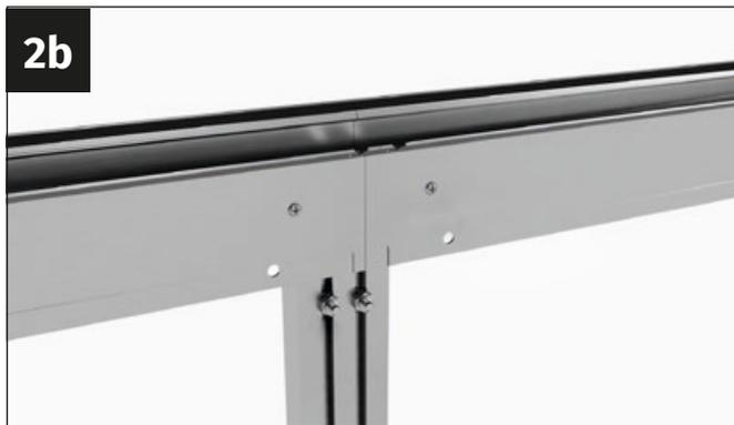
Introduce un tornillo M6x12 mm en el canal de atornillado izquierdo y derecho del puntal de acoplamiento.
