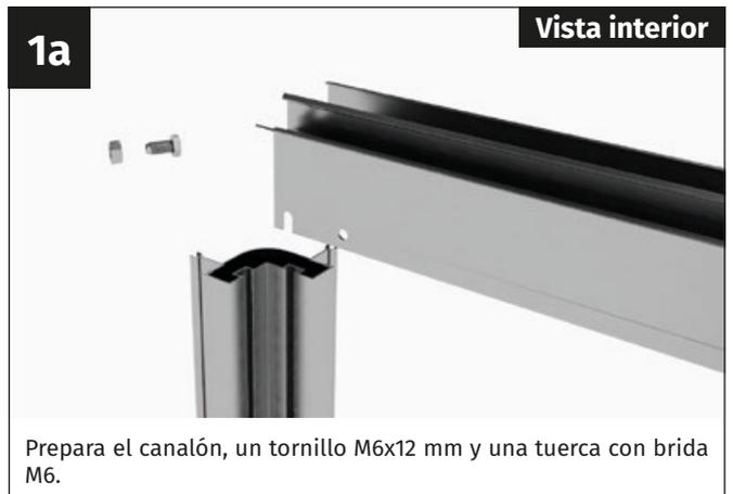
Prepara el canalón, un tornillo M6x12 mm y una tuerca con brida M6.
