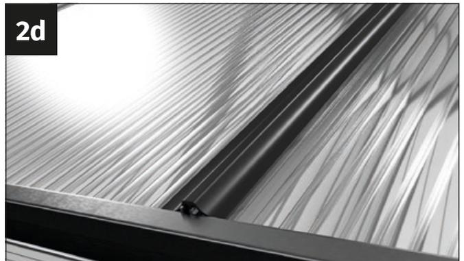
Presiona el perfil de goma firmemente en el puntal hasta que los ganchos encajen en el perfil y el perfil de goma se sujete firmemente.
