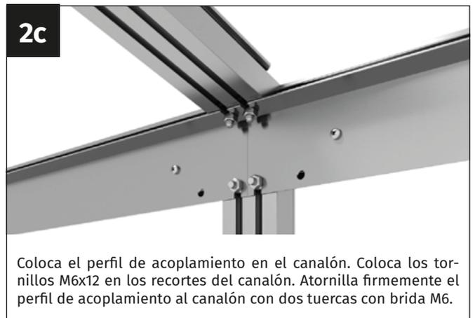
Coloca el perfil de acoplamiento en el canalón. Coloca los tornillos M6x12 en los recortes del canalón. Atornilla firmemente el perfil de acoplamiento al canalón con dos tuercas con brida M6.
