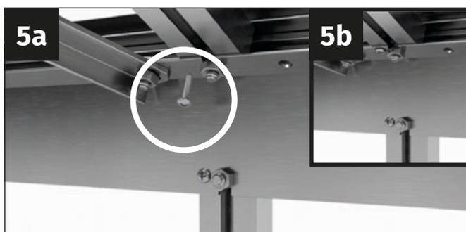
Continúa con el canalón y los puntales del techo. Atornilla el canalón y los puntales del techo con tornillos autorroscantes de 4,8 x 13 mm.
