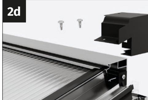
Prepara la tapa de la cumbrera y dos tornillos auto perforantes de 4,8 x 13 mm para el montaje. A pesar de los tornillos auto perforantes, recomendamos taladrar previamente con una broca de 4 mm.
