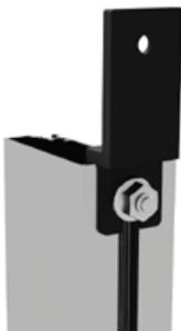
Fija el soporte de cumbrera al soporte de techo. Coloca el tornillo M6x12 mm en el soporte. Atornilla firmemente el soporte con una tuerca con brida M6.
