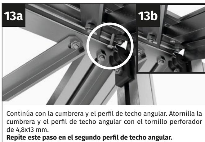
Continúa con la cumbra y el perfil de techo angular. Atornilla la cumbra y el perfil de techo angular con el tornillo perforador de 4,8x13 mm. **Repite este paso en el segundo perfil de techo angular.**
