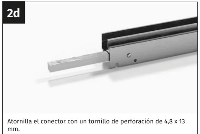
Atornilla el conector con un tornillo de perforación de 4,8 x 13 mm.
