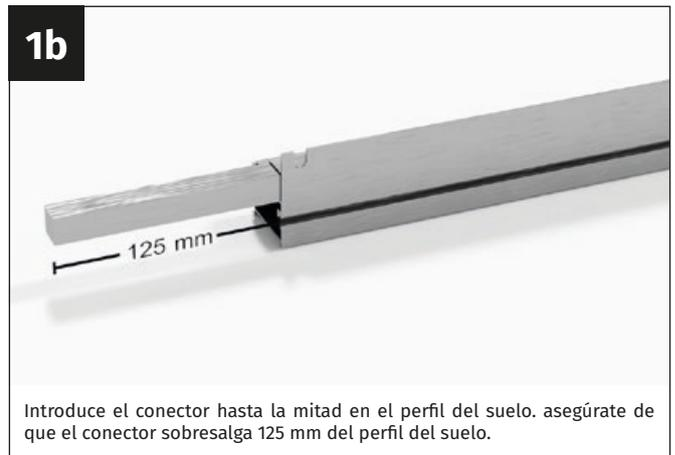
Introduce el conector hasta la mitad en el perfil del suelo. asegúrate de que el conector sobresalga 125 mm del perfil del suelo.
