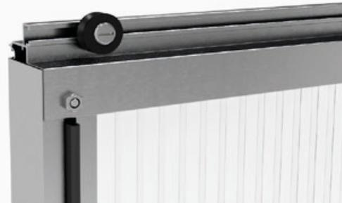
Atornilla el perno del eje a la tuerca. **Recomendamos colocar el rodillo de la puerta a unos 40 mm del extremo del perfil del rodillo de la puerta.**
