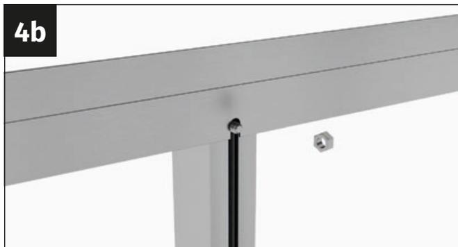
Introduce un tornillo M6x12 mm en el canal de atornillado del perfil de entrada de la puerta y colócalo en la sección perforada de los refuerzos transversales.
