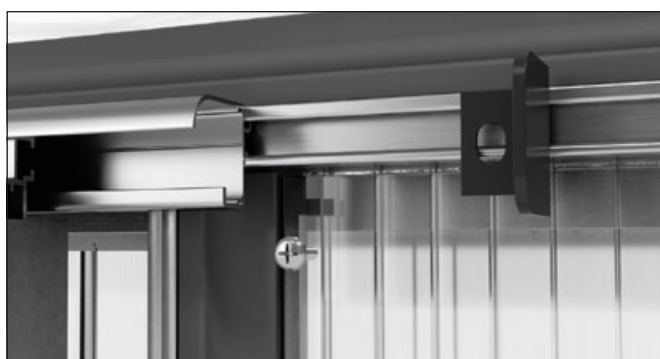
Aseta ovikiskon suojus oven kaiteen sadekourusta poispäin olevalle puolelle. Käytä 4,8 x 13 mm itseporautuvaa ruuvia kiinnittäksesi oven kiskosuojan.
