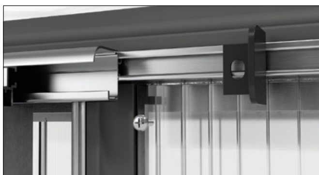
Plaats de deurrailbeveiliging aan de kant van de deurrail die van de regengoot af wijst. Gebruik de 4,8×13 mm boorschroef om de deurrailbescherming te bevestigen.
