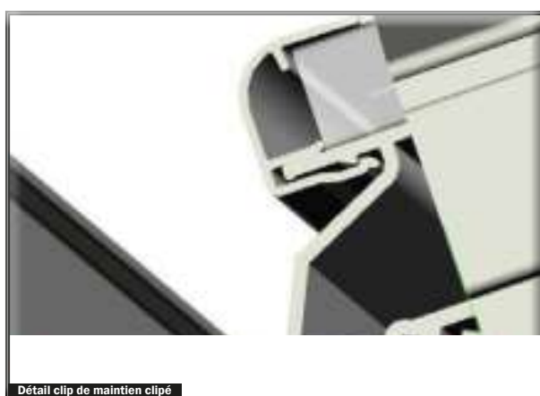
Détail clip de maintien clipé
