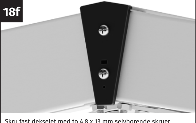
Skru fast dekselet med to 4,8 x 13 mm selvborende skruer.
