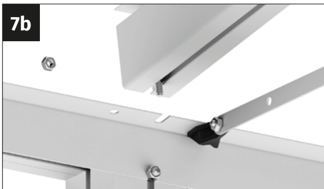
Sätt i M6x12 mm skruven i skruvkanalen på takbjälken.
