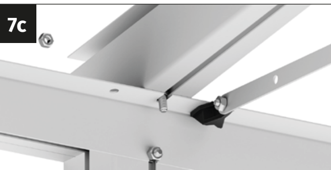
Placera takbjälken på den längsgående balken och sätt i M6x12 mm skruven i den förberedda utskärningen i den längsgående balken. Personen på stegen ska hålla i och säkra takbjälkens överkant.
