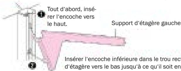
Insérer l'encoche inférieure dans le trou rectangulaire, pousser le support d'étagère vers le bas jusqu'à ce qu'il soit en place au fond du trou.
