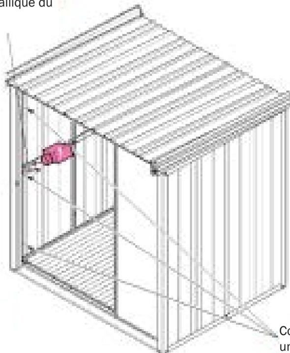
Couvrir le trou de vis avec un boulon pour fixer le mur
