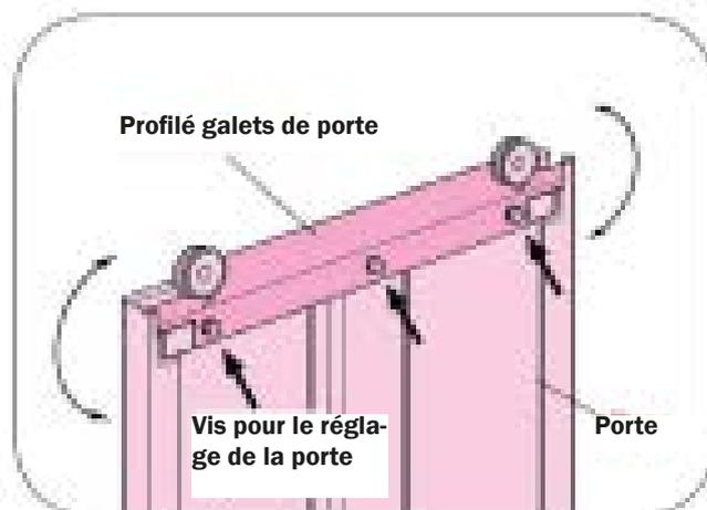
**Remarque** Si le réglage ne fonctionne pas, vérifier que le support est bien à plat ou si les pièces ont été correctement alignées lors du montage !
