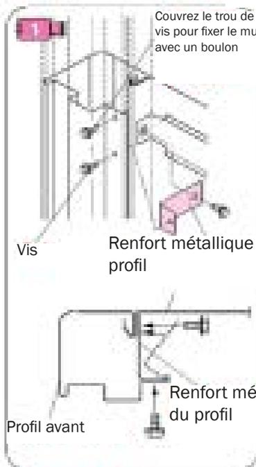
Couvrez le trou de vis pour fixer le mur avec un boulon
