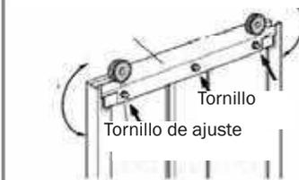
Si resulta difícil mover la pared frontal, afloja los tres tornillos de la parte inferior y mueve la puerta de nuevo. Si ahora se mueve sin problemas, vuelve a apretar los tornillos.
