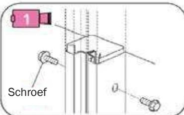
**Opmerking** Als er een tussenruimte ontstaat tussen het wandpaneel en het vloerframe of als twee aangrenzende gaten niet verticaal gelijk zijn, is de constructie niet in evenwicht of niet goed uitgelijnd.
