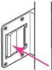
Als het schuurtje van binnenuit is ontgrendeld, moet de sleutel weer 180 graden linksom worden gedraaid voordat het schuurtje weer kan worden afgesloten.
