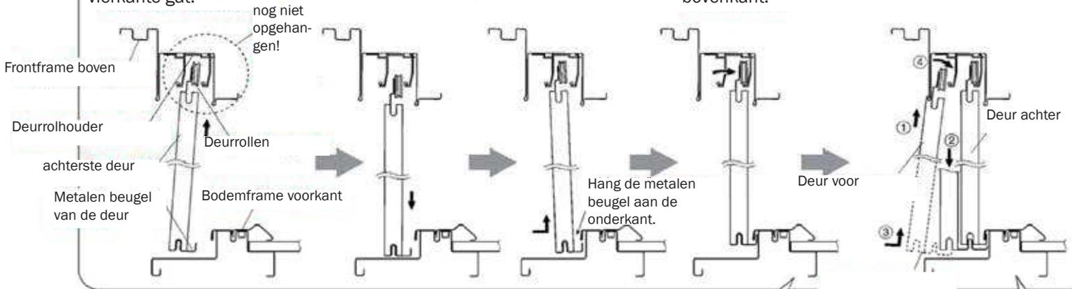
③ Bevestig de deurstopper zodat er een opening van ongeveer 4 mm overblijft voor de deurversterking.
