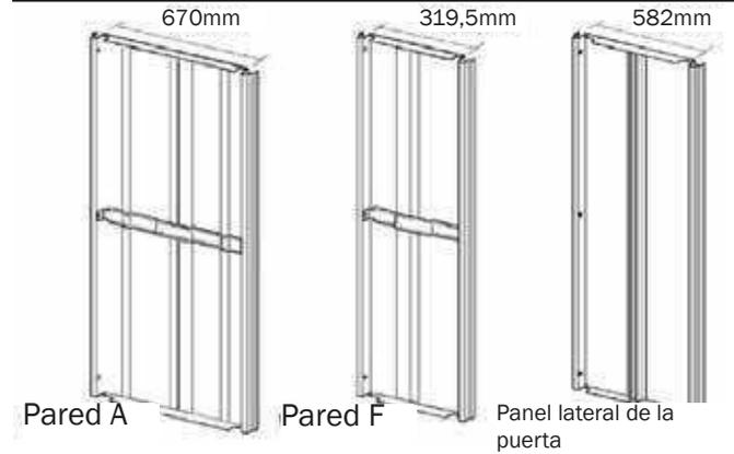
**Nota** En caso de que haya un espacio entre la pared y el marco inferior o de que dos orificios adyacentes no fueran verticalmente idénticos, significa que la construcción no está situada sobre una superficie plana o que no está bien montada.
