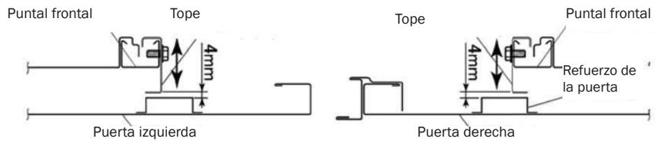
**Si la puerta es difícil de mover, afloja los tres tornillos de la parte inferior y vuelve a mover la puerta. Si ahora se mueve con mucha facilidad, vuelve a apretar los tornillos.**
