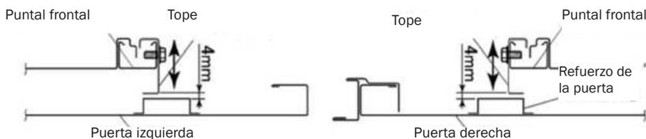
**Si la puerta es difícil de mover, afloja los tres tornillos de la parte inferior y vuelve a mover la puerta. Si ahora se mueve con mucha facilidad, vuelve a apretar los tornillos.**
