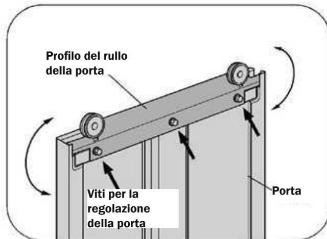
**Avvertenza** Se la regolazione non funziona, controllare che il sottofondo sia piano e regolare e che le parti siano state allineate correttamente durante la costruzione!
