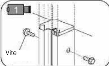
**Avvertenza** Se tra il pannello della parete e il telaio del pavimento c'è una fessura o se due fori adiacenti non sono verticalmente congruenti, la struttura non è in equilibrio o non è allineata correttamente!
