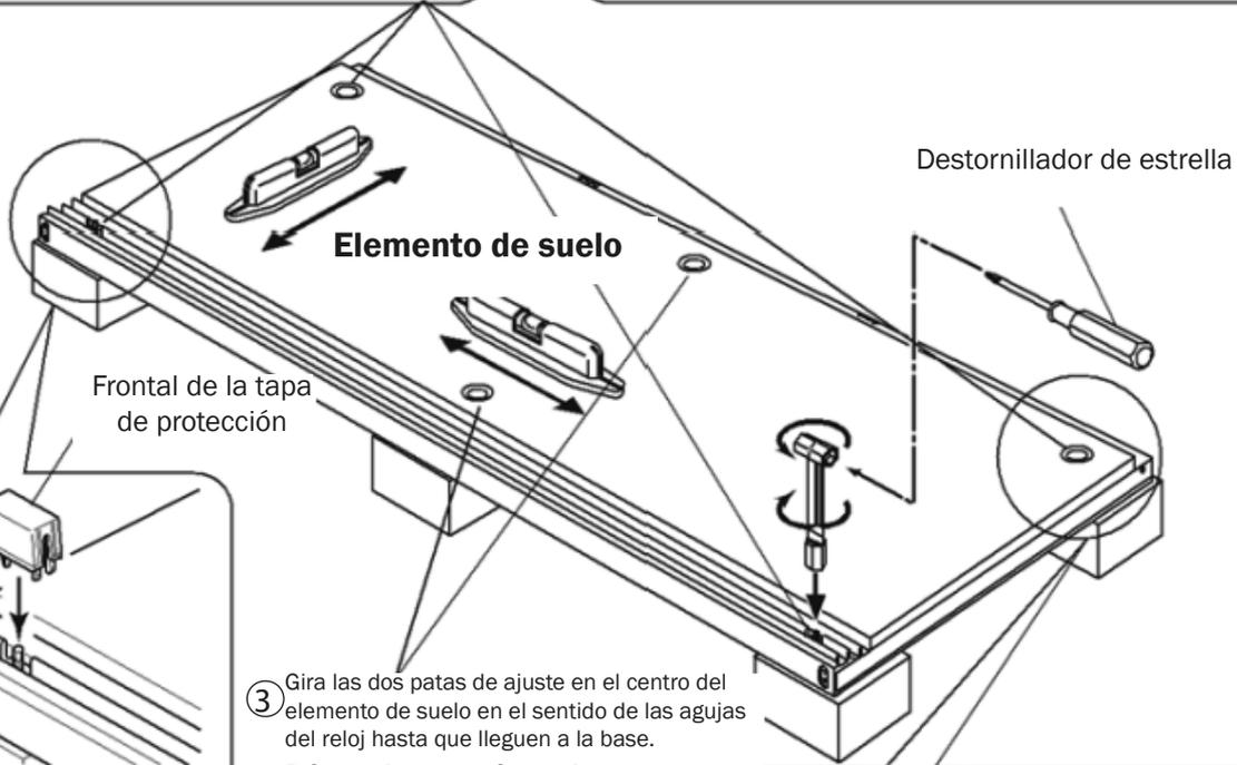
③ Gira las dos patas de ajuste en el centro del elemento de suelo en el sentido de las agujas del reloj hasta que lleguen a la base.
