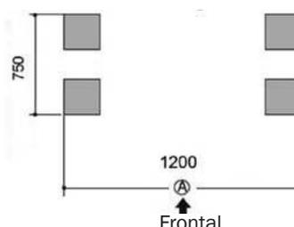
Asegúrate de que los puntos de apoyo sean planos y tengan las mismas dimensiones y altura. Asegúrate de dejar el espacio necesario con las paredes adyacentes, etc. para el montaje.
