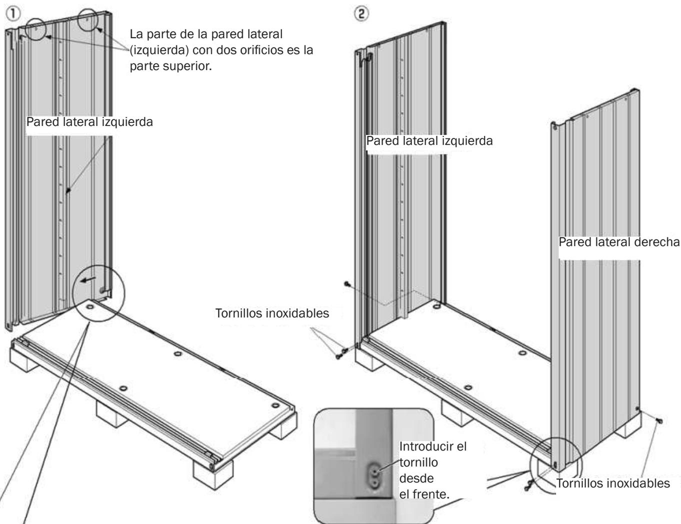
a. Coloca la esquina posterior inferior de la pared lateral (izquierda) en la ranura del lateral del elemento de suelo.
