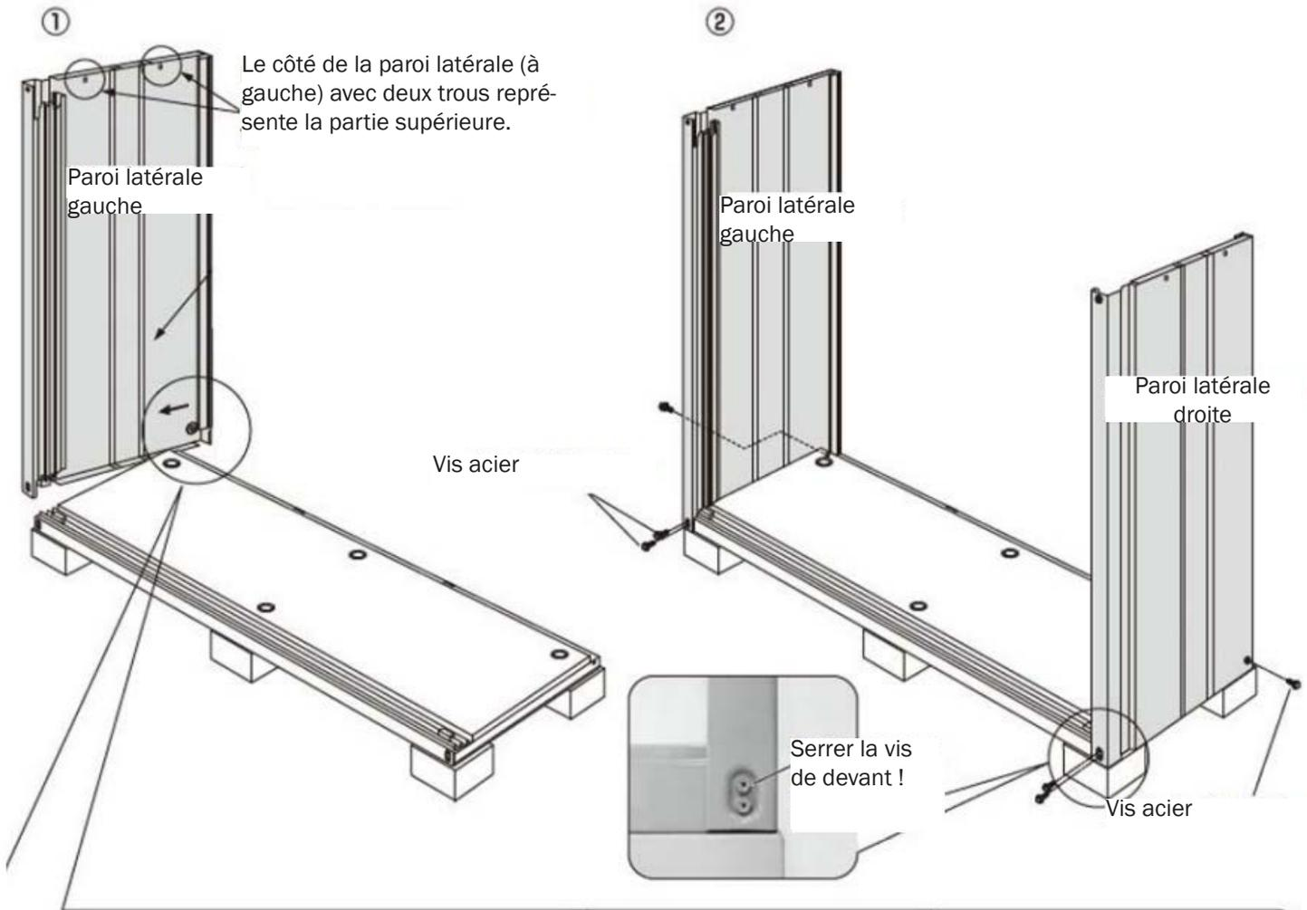
a. Insérer le coin inférieur arrière de la paroi latérale (à gauche) dans la rainure sur le côté de la planche de sol.
