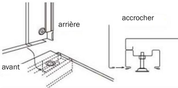
b. Accrocher la pince sur le côté arrière de la paroi latérale dans la fente de la planche de sol.
