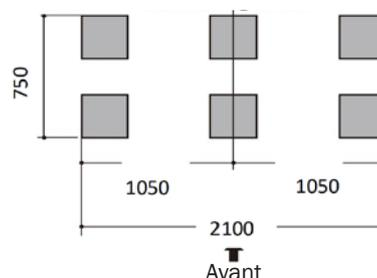
Veiller à ce que les points d'appui soient bien alignés et orientés à 90°.
