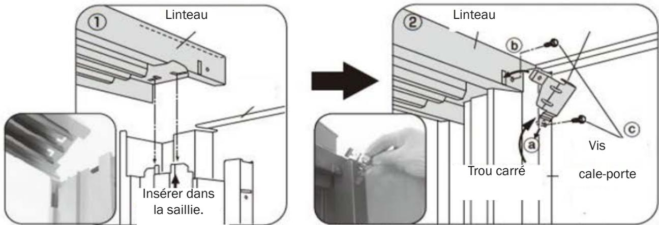
il y a des connecteurs métalliques pour le linteau à gauche et à droite.
