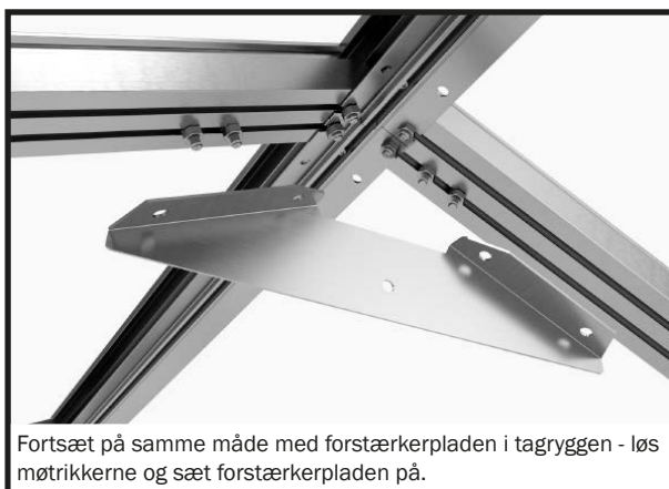
Fjern møtrikkerne fra skrueene, der er sat i samlingsprofilerne, placer skrueene i hullerne i forstærkerpladen og juster pladen så den sidder i vinkel.
