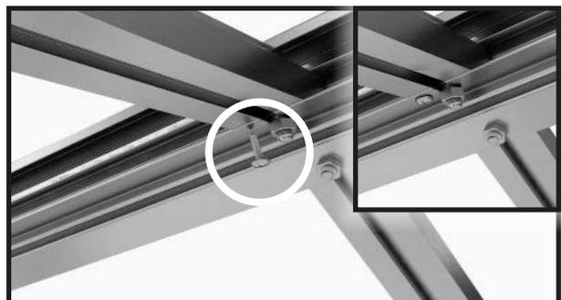
Continuez avec le profilé de faîtière et les entretoises de toit. Vissez les deux avec la vis de forage 4,8x13 mm.
