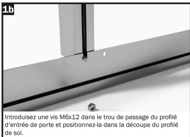
Introduisez une vis M6x12 dans le trou de passage du profilé d'entrée de porte et positionnez-la dans la découpe du profilé de sol.
