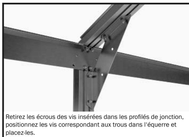
Retirez les écrous des vis insérées dans les profilés de jonction, positionnez les vis correspondant aux trous dans l'équerre et placez-les.
