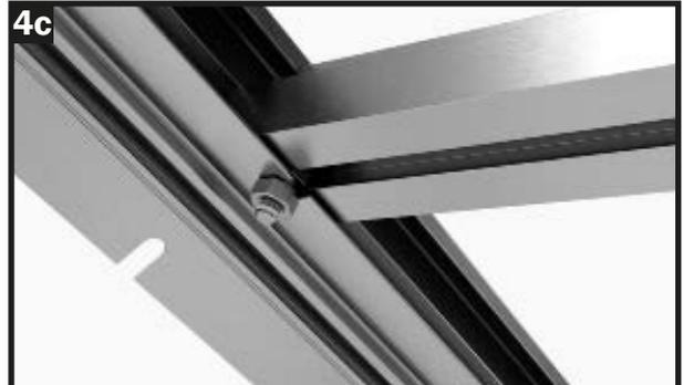
Vissez fermement l'entretoise de toit au profilé de faîtière avec un écrou M6 avec un écrou M6.
