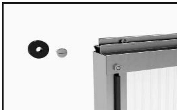
Insérez l'écrou dans le rail de guidage de porte.
