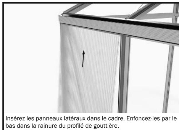
Insérez les panneaux latéraux dans le cadre. Enfoncez-les par le bas dans la rainure du profilé de gouttière.
