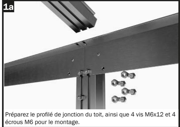
Préparez le profilé de jonction du toit, ainsi que 4 vis M6x12 et 4 écrous M6 pour le montage.
