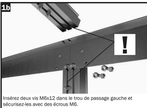
Insérez deux vis M6x12 dans le trou de passage gauche et sécurisez-les avec des écrous M6.
