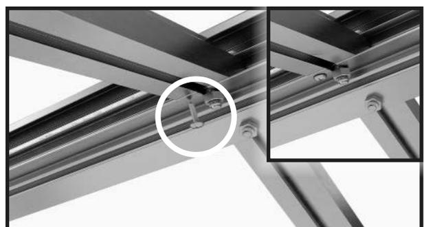
Continuare con il colmo e i puntelli del tetto. Avvitare il colmo e i puntelli del tetto con la vite perforante da 4,8x13 mm.
