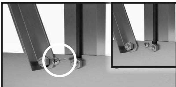
Continuare con il profilo di ingresso della porta e il profilo del pavimento. Avvitare il profilo di ingresso della porta e il profilo del pavimento con la vite perforante da 4,8x13 mm.
