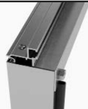
Avvitare saldamente il profilo del rullo della porta al profilo laterale della porta utilizzando la vite autofilettante 4,8x22 mm. Ripetere questi passaggi su tutti e quattro gli angoli.
