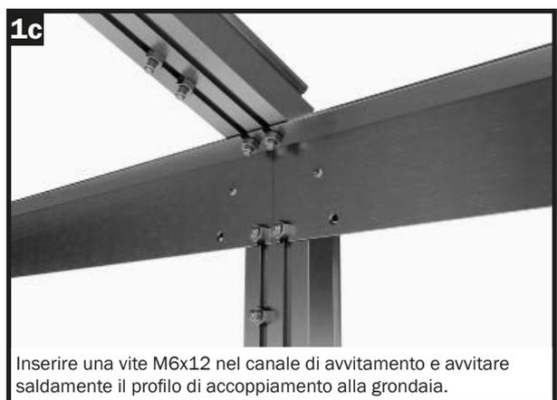
Inserire una vite M6x12 nel canale di avvitamento e avvitare saldamente il profilo di accoppiamento alla grondaia.
