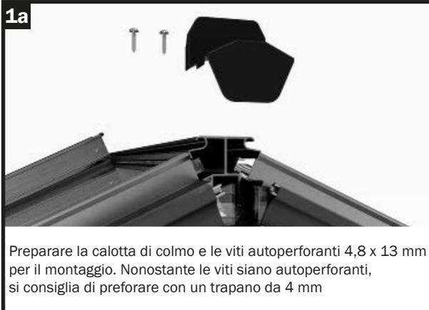
Preparare la calotta di colmo e le viti autoperforanti 4,8 x 13 mm per il montaggio. Nonostante le viti siano autoperforanti, si consiglia di preforare con un trapano da 4 mm
