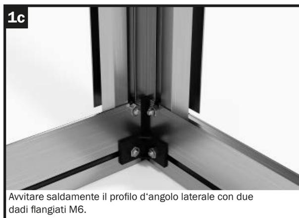
Avvitare saldamente il profilo d'angolo laterale con due dadi flangiati M6.
