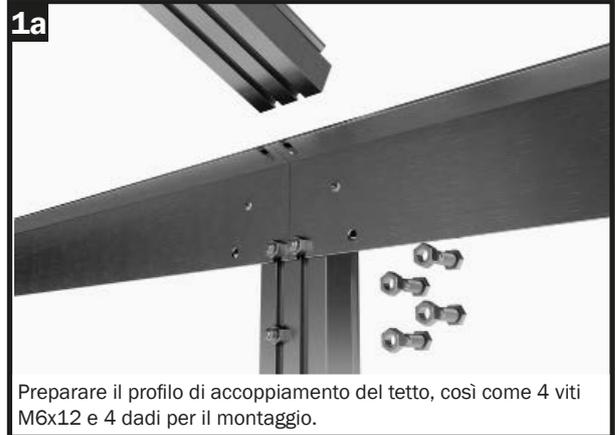
Preparare il profilo di accoppiamento del tetto, così come 4 viti M6x12 e 4 dadi per il montaggio.
