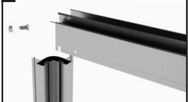
Bereiten Sie die Regenrinne, sowie eine Schraube M6x12 und eine Flanschmutter M6 vor.
