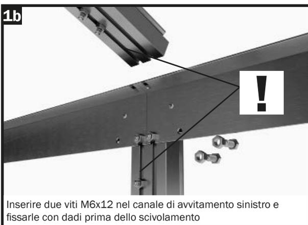
Inserire due viti M6x12 nel canale di avvitamento sinistro e fissarle con dadi prima dello scivolamento
