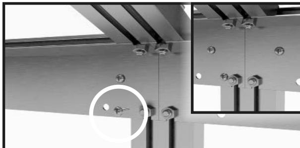
Continuare con la grondaia e i profili di accoppiamento della parete laterale. Avvitare la grondaia e il profilo di accoppiamento della parete laterale con la vite perforante da 4,8x13 mm.
