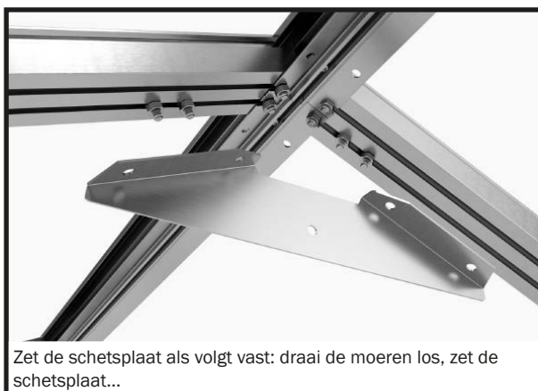
Verwijder de moeren van de schroeven die in de koppelprofielen zijn geplaatst, positioneer de schroeven overeenkomstig de gaten in de schetsplaat en plaats deze.
