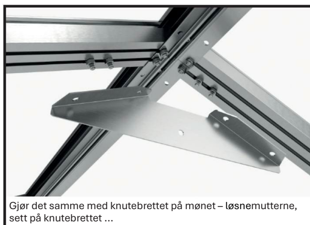
Fjern mutrene fra skruene som er satt inn i koblingsprofilene, plasser skruene i henhold til hullene i knutebrettet og sett dette på.
