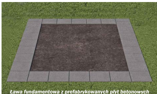
Ława fundamentowa z prefabrykowanych płyt betonowych
