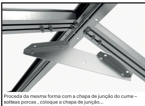
Retire as porcas dos parafusos inseridos nos perfis de acoplamento , posicione os parafusos de acordo com os orifícios na chapa de junção e coloque-a.
