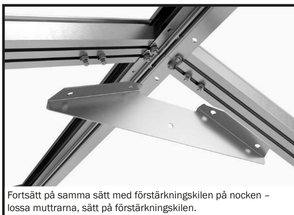
Ta bort muttrarna från skruvarna som används i kopplingsprofilerna, placera skruvarna i enlighet med hålen i förstärkningskilen och sätt på den.
