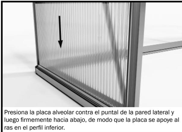
Presiona la placa alveolar contra el puntal de la pared lateral y luego firmemente hacia abajo, de modo que la placa se apoye al ras en el perfil inferior.
