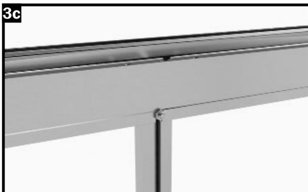
Atornilla firmemente el puntal al canalón con una tuerca de brida M6.
