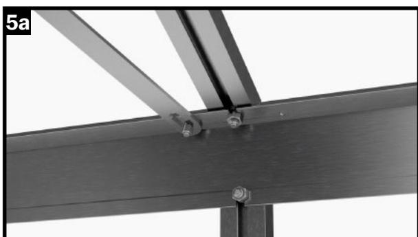
Para atornillar el tirante, pasa un tornillo M6x12 desde el exterior a través del orificio perforado del canalón y luego coloca el tirante.
