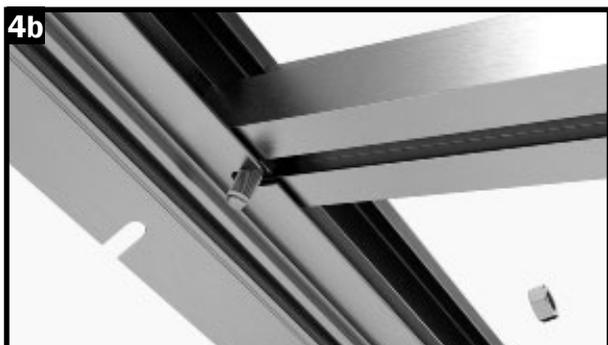
Introduce el tornillo M6x12 en el canal de atornillado del puntal de techo y coloca el tornillo en los orificios del perfil de cumbrera previstos para el atornillado.
