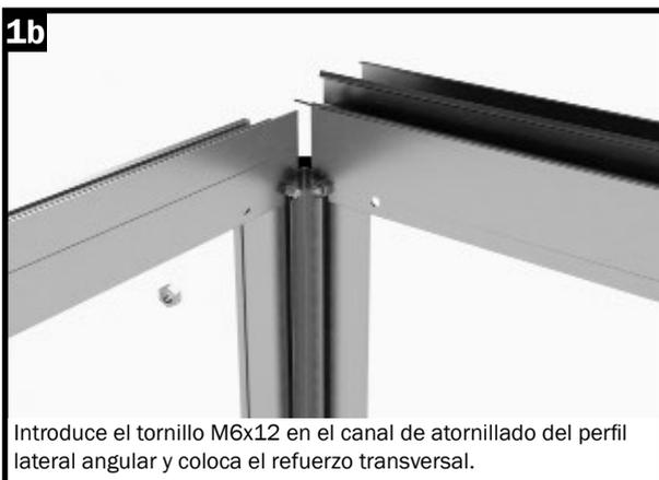
Introduce el tornillo M6x12 en el canal de atornillado del perfil lateral angular y coloca el refuerzo transversal.
