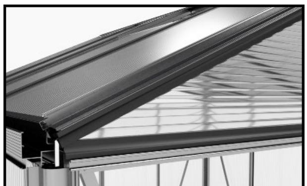
Monta la mitad de la goma en el refuerzo transversal, de forma que las placas del gablete estén sujetas alrededor con perfiles de goma.
