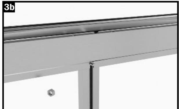
Coloca el tornillo en el orificio del canalón.
