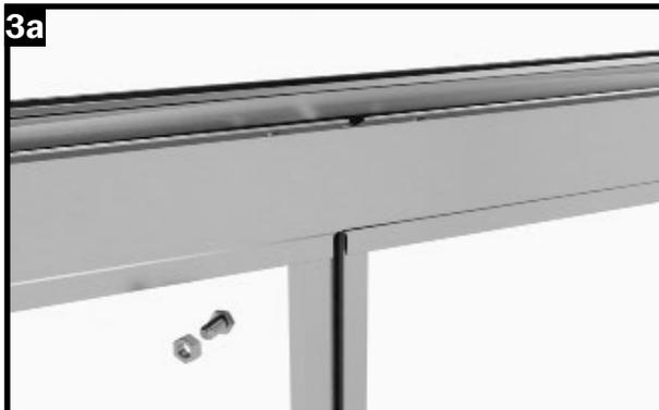
Introduce un tornillo M6x12 en el canal de atornillado del puntal.
