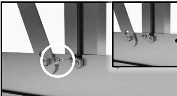
Continúa con el perfil de suelo y los puntales de la pared. Atornilla el perfil del suelo y los puntales de la pared con el tornillo perforador de 4,8x13 mm.
