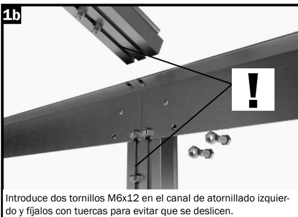
Introduce dos tornillos M6x12 en el canal de atornillado izquierdo y fíjalos con tuercas para evitar que se deslicen.
