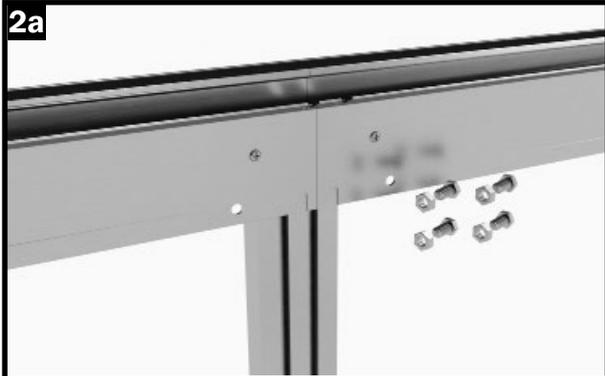
**ATENCIÓN:** En la parte superior del perfil de acoplamiento se necesitan cuatro tornillos M6x12 y cuatro tuercas de brida M6.
