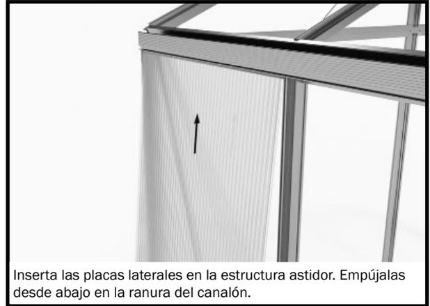
Inserta las placas laterales en la estructura astidor. Empújalas desde abajo en la ranura del canalón.
