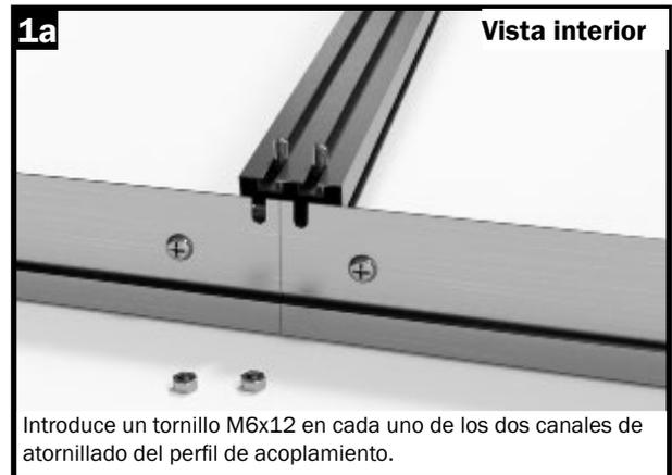
Introduce un tornillo M6x12 en cada uno de los dos canales de atornillado del perfil de acoplamiento.
