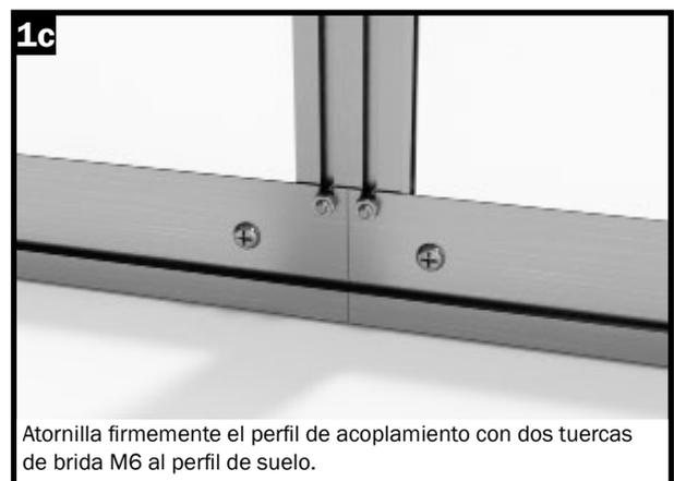
Atornilla firmemente el perfil de acoplamiento con dos tuercas de brida M6 al perfil de suelo.
