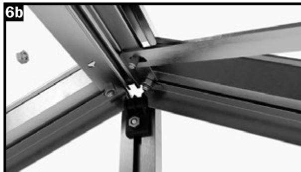
Para atornillar el tirante, inserta un tornillo M6x12 desde el exterior a través del orificio perforado del perfil de cumbrera y, a continuación, coloca el tirante.
