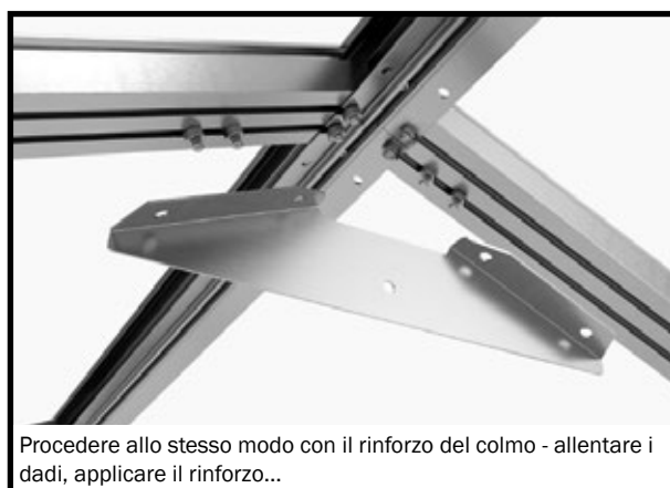
Rimuovere i dadi dai bulloni inseriti nei profili di accoppiamento, posizionare i bulloni estraendo i fori nella piastra di rinforzo e applicarli.
