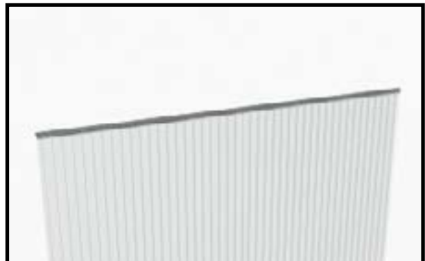
Påfør teipen godt på dobbeltveggspplater.
