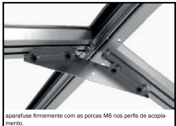
Aparafuse a chapa de junção com as porcas de flange firmemente aos perfis de acoplamento.
