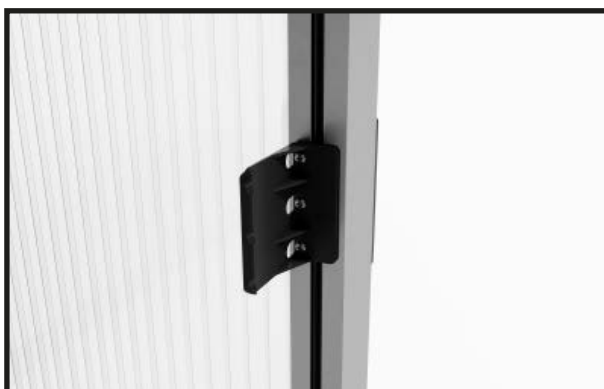
Skrue dørhåndtagene fast med 4,8 x 13 mm selvborende skruer.
