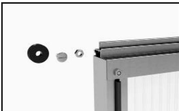
Prepara las ruedas de la puerta, los pernos del eje y las tuercas M6 para el montaje.
