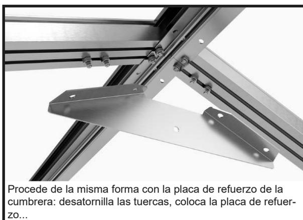
Procede de la misma forma con la placa de refuerzo de la cumbrera: desatornilla las tuercas, coloca la placa de refuerzo...
