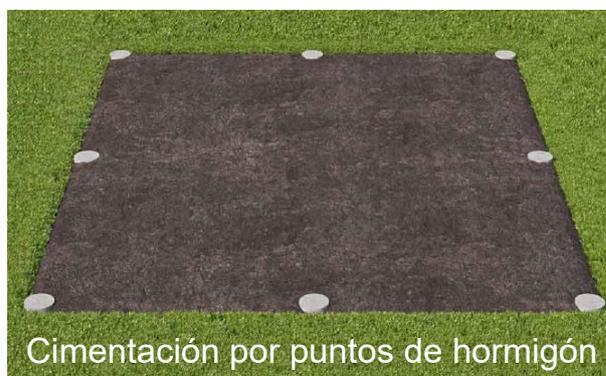
Cimentación por puntos de hormigón
