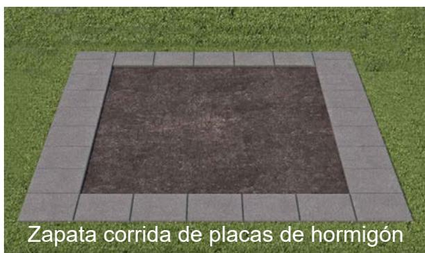
Zapata corrida de placas de hormigón
