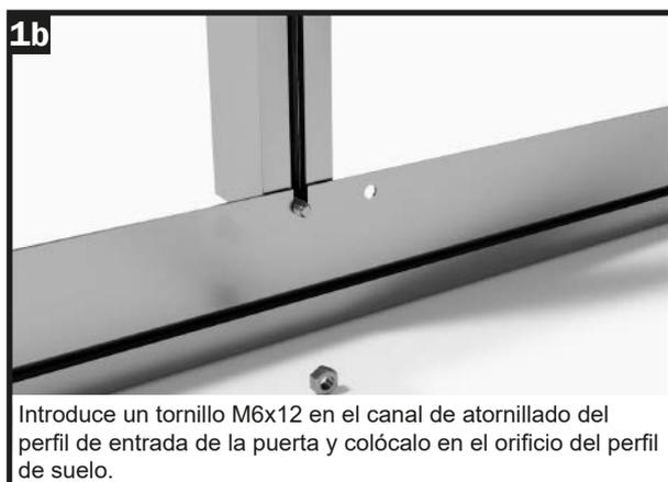
Introduce un tornillo M6x12 en el canal de atornillado del perfil de entrada de la puerta y colócalo en el orificio del perfil de suelo.
