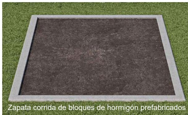
Zapata corrida de bloques de hormigón prefabricados
