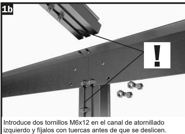
Introduce dos tornillos M6x12 en el canal de atornillado izquierdo y fíjalos con tuercas antes de que se deslicen.
