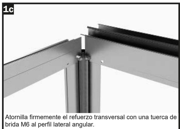
Atornilla firmemente el refuerzo transversal con una tuerca de brida M6 al perfil lateral angular.
