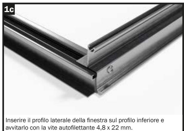
Inserire il profilo laterale della finestra sul profilo inferiore e avvitarlo con la vite autofilettante 4,8 x 22 mm.
