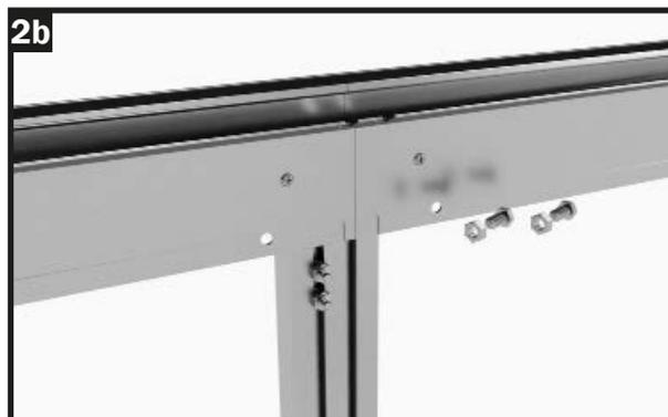
Inserire due viti M6x12 nel canale di avvitamento sinistro e fissarle con dadi flangiati M6 in modo che non scivolino.
