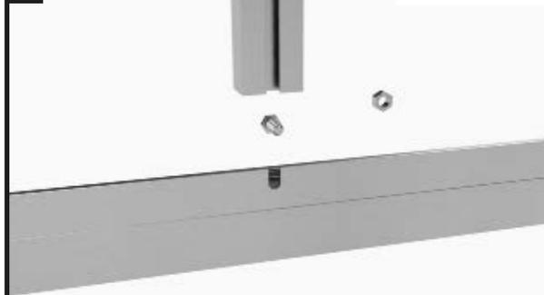
Prendere il supporto del tetto, una vite M6x12 e un dado flangiato M6 per il montaggio.
