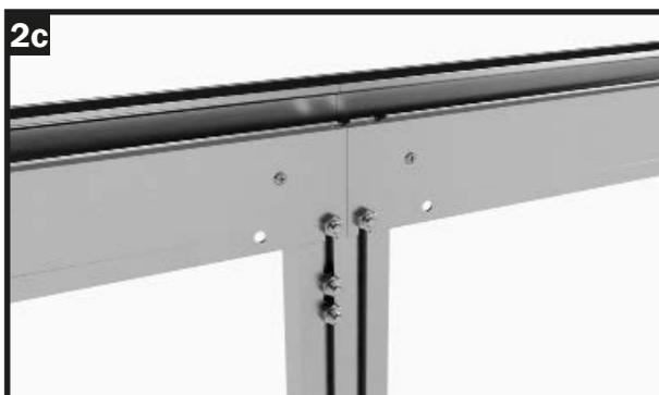
Inserire una vite M6x12 nel canale di avvitamento e avvitare saldamente il profilo di accoppiamento alla grondaia.
