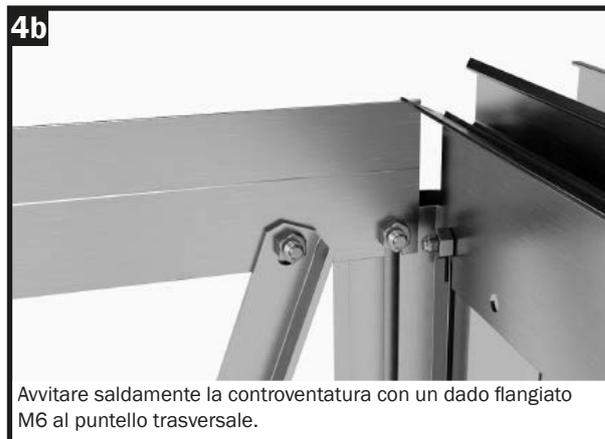
Avvitare saldamente la controventatura con un dado flangiato M6 al puntello trasversale.
