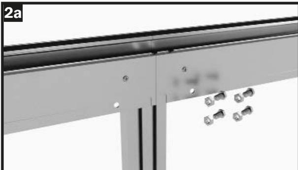
**ATTENZIONE:** nella parte superiore del profilo di accoppiamento sono necessarie quattro viti M6x12 e quattro dadi flangiati M6.
