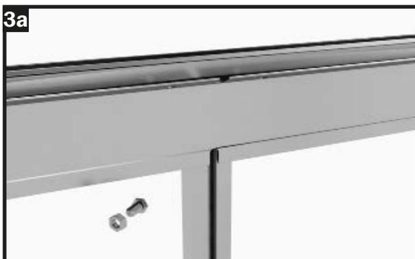
Inserire una vite M6x12 nel canale di avvitamento del puntello.
