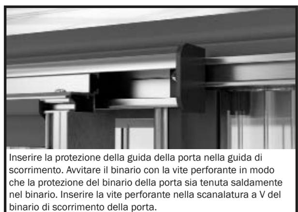
Inserire la protezione della guida della porta nella guida di scorrimento. Avvitare il binario con la vite perforante in modo che la protezione del binario della porta sia tenuta saldamente nel binario. Inserire la vite perforante nella scanalatura a V del binario di scorrimento della porta.
