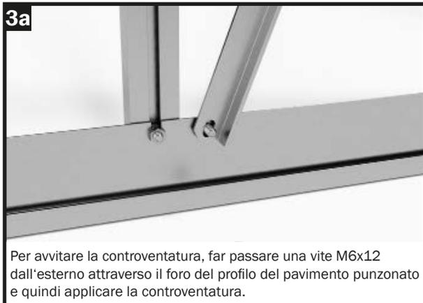
Per avvitare la controventatura, far passare una vite M6x12 dall'esterno attraverso il foro del profilo del pavimento punzonato e quindi applicare la controventatura.
