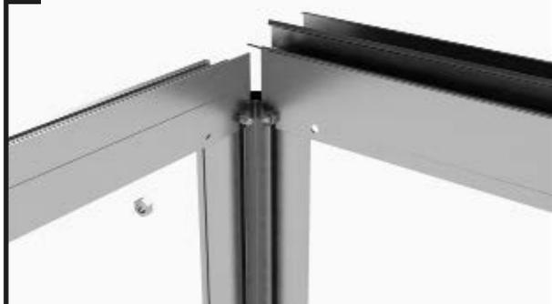
Inserire la vite M6x12 nel canale di avvitamento del profilo angolare laterale e posizionare il puntello trasversale.
