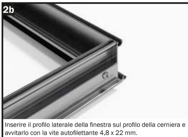
Inserire il profilo laterale della finestra sul profilo della cerniera e avvitarlo con la vite autofilettante 4,8 x 22 mm.
