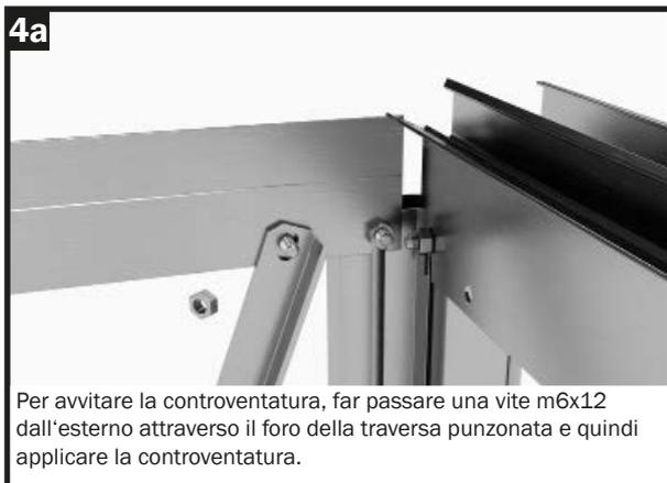
Per avvitare la controventatura, far passare una vite m6x12 dall'esterno attraverso il foro della traversa punzonata e quindi applicare la controventatura.
