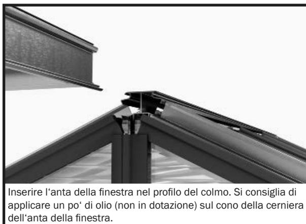
Inserire l'anta della finestra nel profilo del colmo. Si consiglia di applicare un po' di olio (non in dotazione) sul cono della cerniera dell'anta della finestra.
