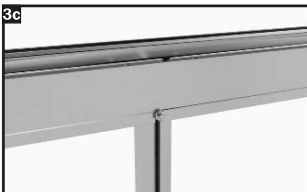
Avvitare saldamente il puntello alla grondaia con un dado flangiato M6.
