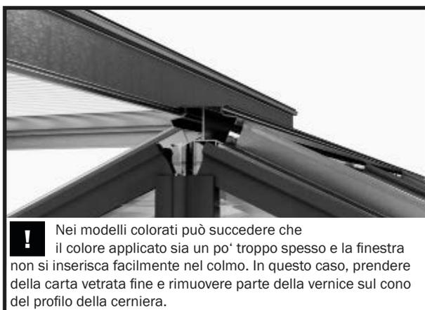
**!** Nei modelli colorati può succedere che il colore applicato sia un po' troppo spesso e la finestra non si inserisca facilmente nel colmo. In questo caso, prendere della carta vetrata fine e rimuovere parte della vernice sul cono del profilo della cerniera.
