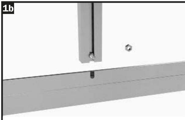
Inserire la vite M6x12 nel canale della vite del puntello del tetto.
