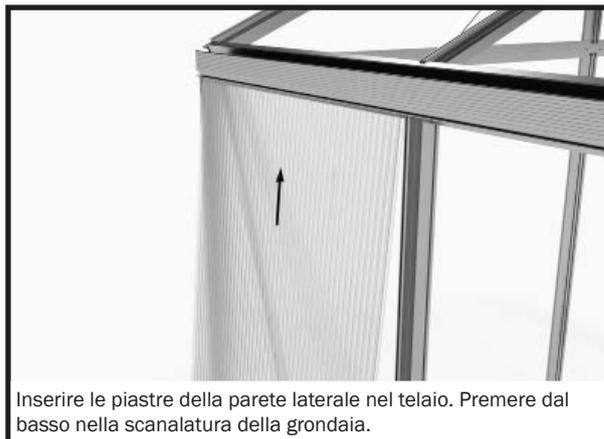
Inserire le piastre della parete laterale nel telaio. Premere dal basso nella scanalatura della grondaia.
