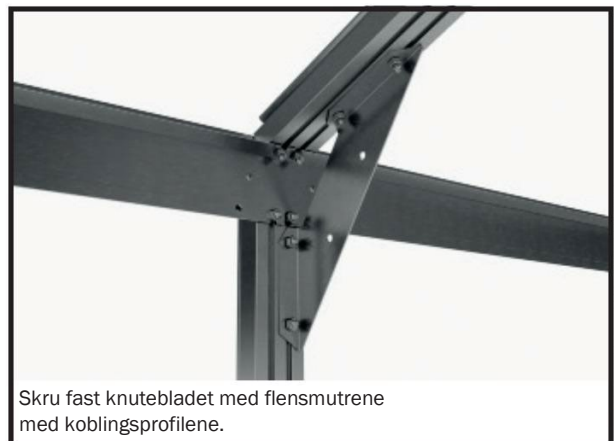
Ta mutrene av skruene som er satt inn i koblingsprofilene, plasser skruene i henhold til hullene i knutebrettet og sett det på.
