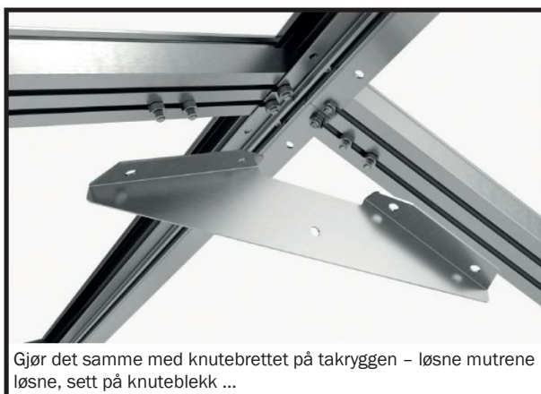
Ta mutrene av skruene som er satt inn i koblingsprofilene, plasser skruene i henhold til hullene i knutebrettet og sett det på.
