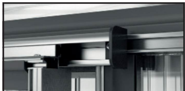
Sett dørskinnebeskyttelsen inn i dørskinnen. Skru fast dørskinnen med boreskruen slik, at dørskinnebeskyttelsen holdes fast i dørskinnen. Sett boreskruen inn i V-sporet på dørskinnen.
