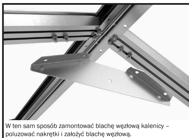
Zdjąć nakrętki ze śrub włożonych w profile łączące, ustawić śruby naprzeciwko otworów w blasze węzłowej i zamontować ją.
