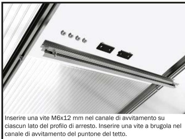
Inserire una vite M6x12 mm nel canale di avvitamento su ciascun lato del profilo di arresto. Inserire una vite a brugola nel canale di avvitamento del puntone del tetto.
