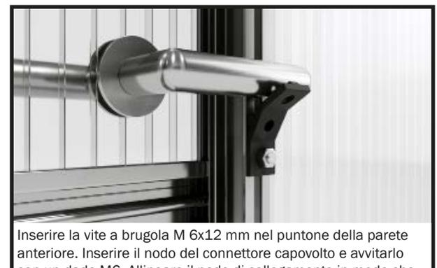
Inserire la vite a brugola M 6x12 mm nel puntone della parete anteriore. Inserire il nodo del connettore capovolto e avvitarlo con un dado M6. Allineare il nodo di collegamento in modo che serva da battuta per la maniglia della porta sul lato interno della serra.
