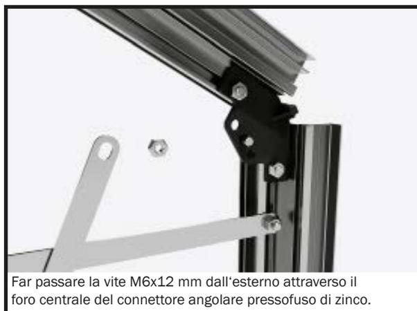
Far passare la vite M6x12 mm dall'esterno attraverso il foro centrale del connettore angolare pressofuso di zinco.
