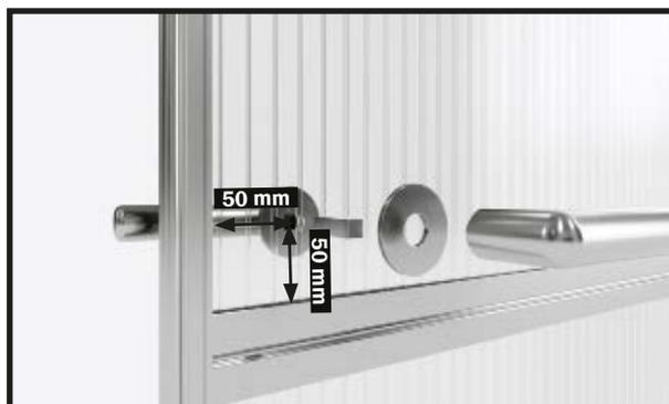
Praticare un foro attraverso il pannello superiore della porta alla distanza sopra indicata. A tal fine, utilizzare un trapano di almeno 10 mm, ma al massimo di 12 mm.
