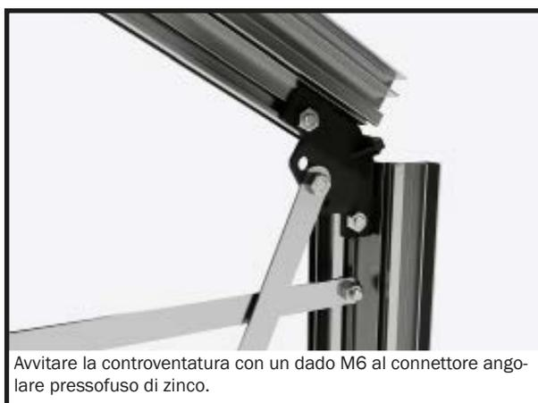
Avvitare la controventatura con un dado M6 al connettore angolare pressofuso di zinco.
