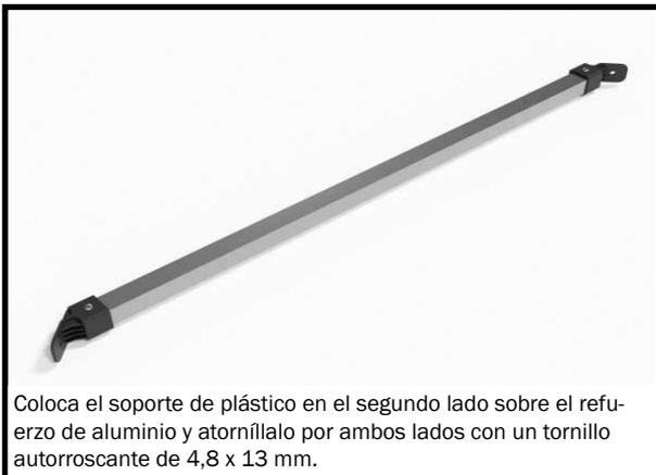
Coloca el soporte de plástico en el segundo lado sobre el refuerzo de aluminio y atorníllalo por ambos lados con un tornillo autorroscante de 4,8 x 13 mm.
