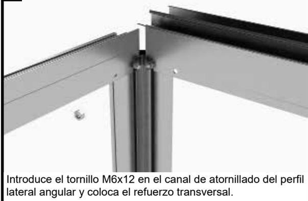
Introduce el tornillo M6x12 en el canal de atornillado del perfil lateral angular y coloca el refuerzo transversal.
