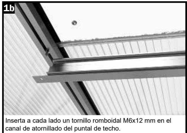
Inserta a cada lado un tornillo romboidal M6x12 mm en el canal de atornillado del puntal de techo.
