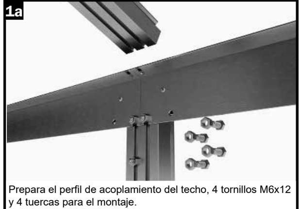
Prepara el perfil de acoplamiento del techo, 4 tornillos M6x12 y 4 tuercas para el montaje.
