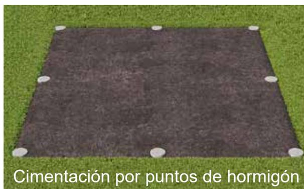
Cimentación por puntos de hormigón
