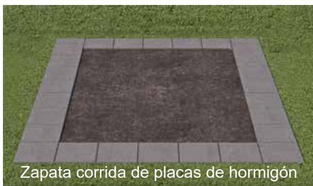
Zapata corrida de placas de hormigón
