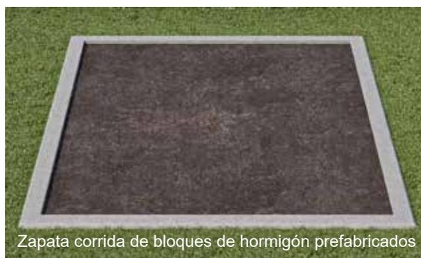
Zapata corrida de bloques de hormigón prefabricados
