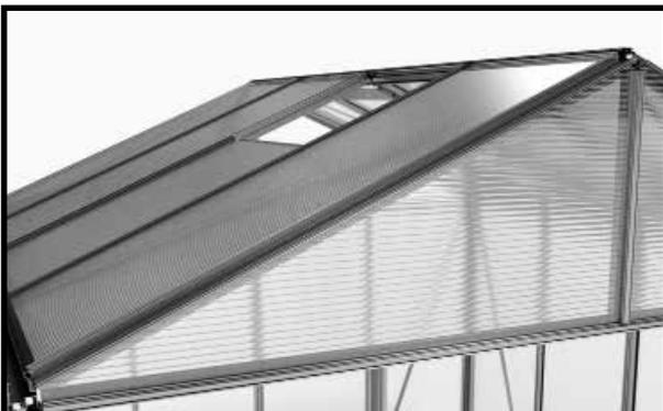
Coloca las placas alveolares de los gabletes angulares en la estructura.
