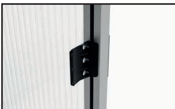
Avvitare le maniglie della porta con viti perforanti da 4,8 x 13 mm.
