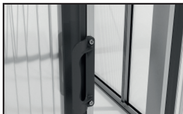
Avvitare la maniglia della porta con viti perforanti da 4,8 x 13 mm.
