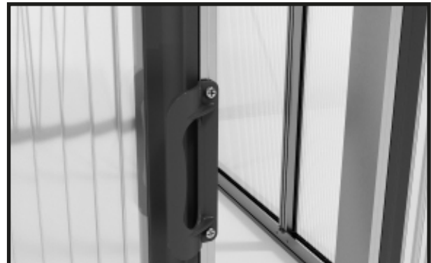
Atornilla el tirador con tornillos perforadores de 4,8 x 13 mm.
