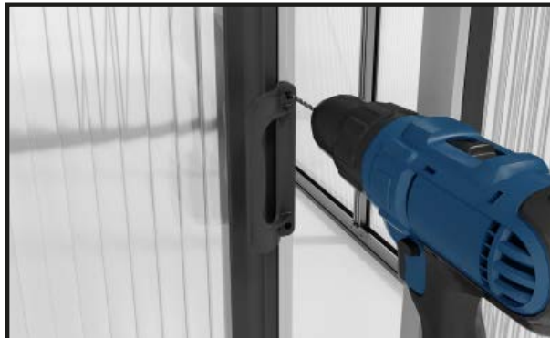
Begin met de buitenste deurgrepen. Boor gaten met een boor van 4 mm.
