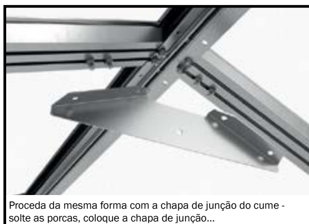
Retire as porcas dos parafusos inseridos nos perfis de ligação, posicione os parafusos de acordo com os orifícios na chapa de junção e coloque-a.
