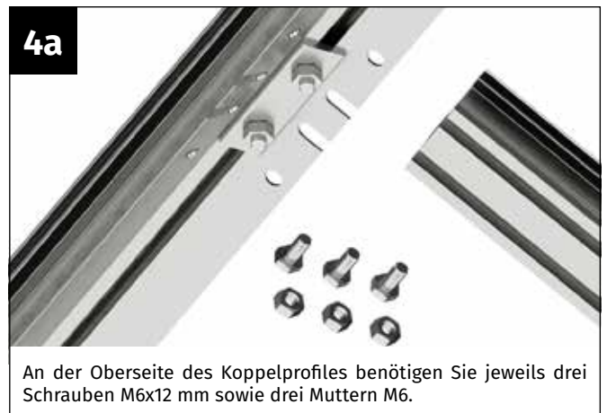
Führen Sie zwei Schrauben M6x12 mm in den linken und eine Schraube in den rechten Schraubkanal des Koppelprofils ein. Legen Sie das Koppelprofil auf und führen Sie zwei Schrauben in die Stanzungen der Regenrinne ein.
