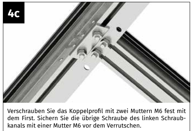
An der Oberseite des Koppelprofils benötigen Sie jeweils drei Schrauben M6x12 mm sowie drei Muttern M6.
