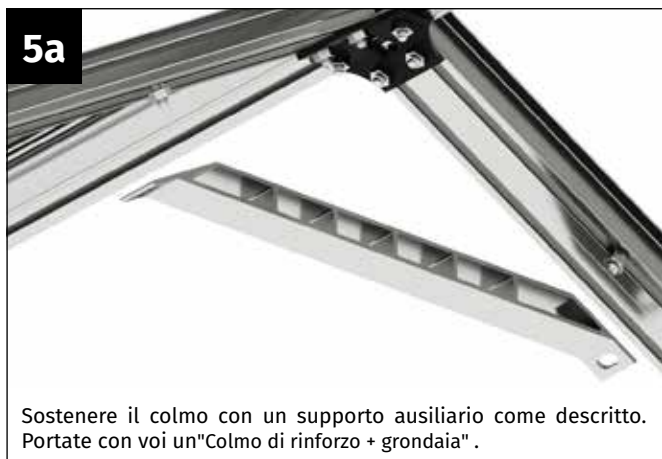
Allentare i dadi M6 delle due viti M6x12 mm inserite nel profilo di accoppiamento.
