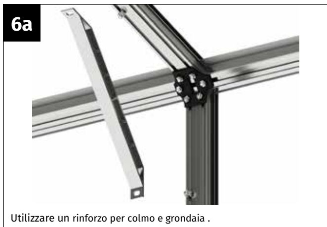
Allineare le viti M6x12 mm in modo da posizionare l'irrigidimento e metterlo in posizione.
