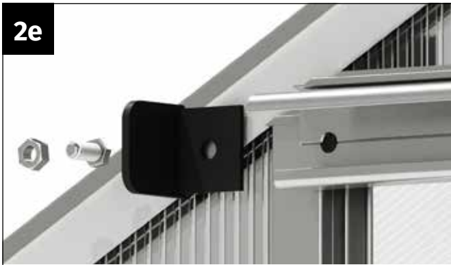
Prendere una protezione per il binario della porta, una vite M6x12 mm e un dado M6.
