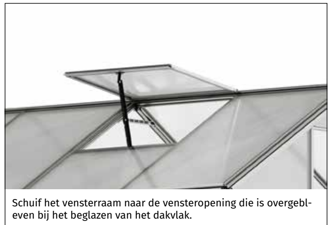
Plaats het venster in het nokprofiel. We raden aan om een beetje olie ( niet meegeleverd ) op de scharnierkegel van het raamvleugel te smeren.
